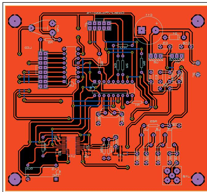
Figure 3 : Implantation du générateur côté composants.
