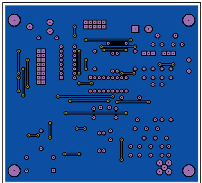
Figure 4 : Implantation du générateur côté soudures.
