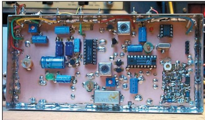
VCO fonctionne en mesurant sur le point test J9, une tension comprise entre 1.2 et 1.5 volts. Enlever la charge et brancher le fréquencemètre via un éventuel atténuateur (~10dB ou suivant sensibilité du fréquencemètre). Amener la fréquence du VCO à 438,5 MHz, en jouant sur CV3.
