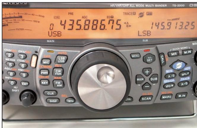
L'afficheur LCD du TS-2000 en mode SAT.
