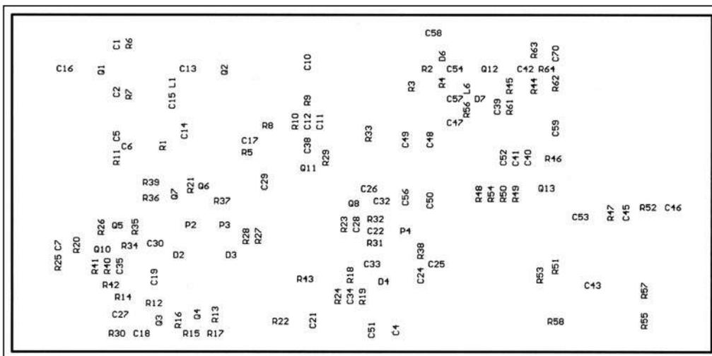
c) Mise en place du BFG235 : avant de souder ce transistor, vérifier qu'il y a bien 2,1 V entre masse et basse de Q1 et que la LED D1 est allumée. Souder le BFG235 et mesurer
