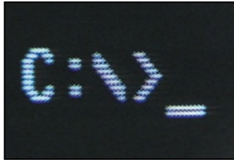
Photo 6 : Sur l'écran d'un ordinateur les caractères sont composés de points.
