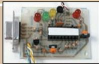
**APRS-MICRO** : L'APRS sans TNC, module autonome géré par PIC, sortie 1200 Bauds AFSK, livré en kit, dimensions réduites (52x40 mm), configuration intégrale via PC (Win 98). APRS-MICRO est livré avec sa documentation française et un CD contenant 129 Mo de logiciels APRS récents : **375 Frs + port 55 Frs**
