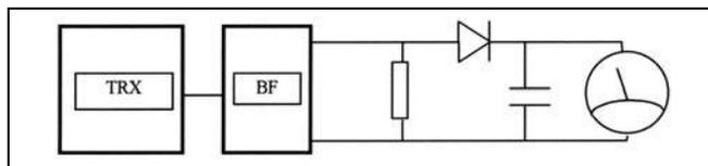
la diode est germanium et le condensateur 4,7 nF. L'utilisation d'un galva à aiguille permet une lecture plus mémorable qu'un affichage numérique, qui n'est pas à exclure suivant les pratiques. Un galva 50 ou 100  $\mu$ A de sensibilité fait l'affaire. Le réglage du seuil se fait par le potentiomètre BF du transceiver.
