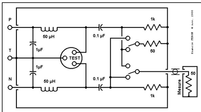
Figure 1 : Réseau en V 50 ohms, 50  $\mu$ H.
