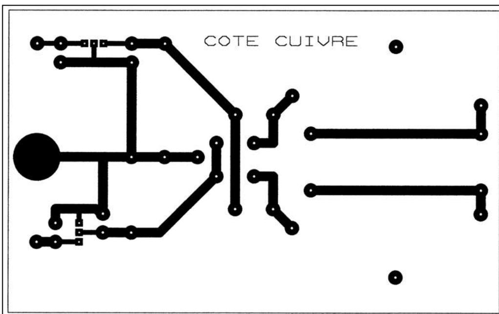
Circuit imprimé de l'alim. du wob BF (côté cuivre).
