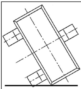
Figure 1 : Le transistor CMS est soudé "incliné".
