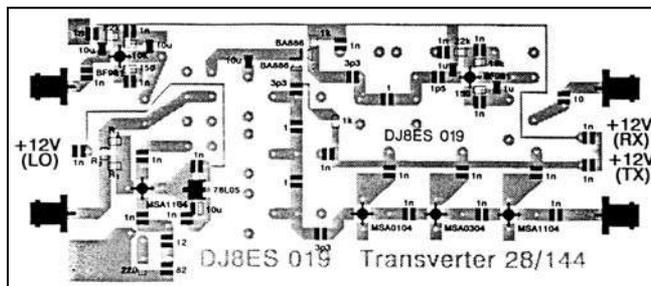
Figure 4 : Le circuit imprimé, côté piste, avec les semi-conducteurs et composants à montage en surface (SMD).
