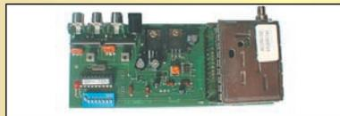
Caractéristiques communes : platines montées et testées, alimentation 13,8 V, sorties audio (6,0 et 6,5 MHz modifiables en 5,0 ou 5,5 MHz) et vidéo sur RCA, sortie HF sur SMA femelle, fréquences fixes (1255, 1250, 1285, 1286,5, 1247, 1282,5, 1279,5 MHz).
