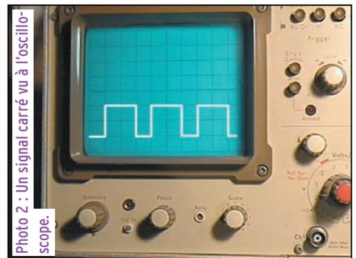
Photo 2 : Un signal carré vu à l'oscilloscope.
