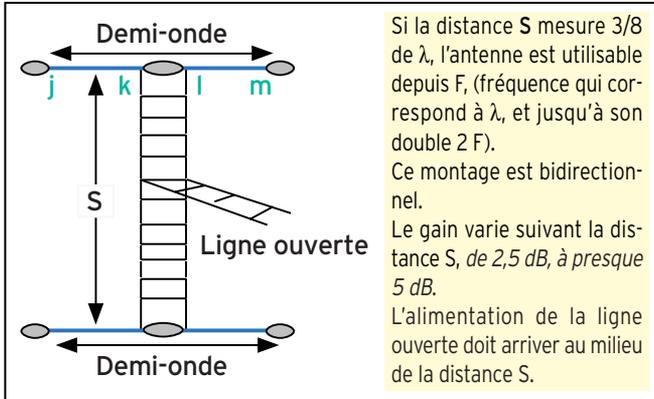
Figure 3 : Simple broadside à éléments horizontaux.
