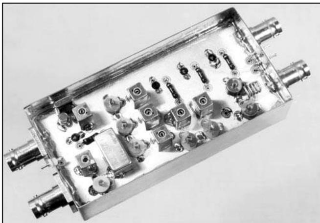
Bien que cela ne soit pas indispensable, le circuit imprimé peut être argenté à froid avant perçage. Les trous adéquats pour les transistors stripline et les amplis large-bande seront percés. Ces composants sont à plat tout contre la surface du circuit imprimé.
