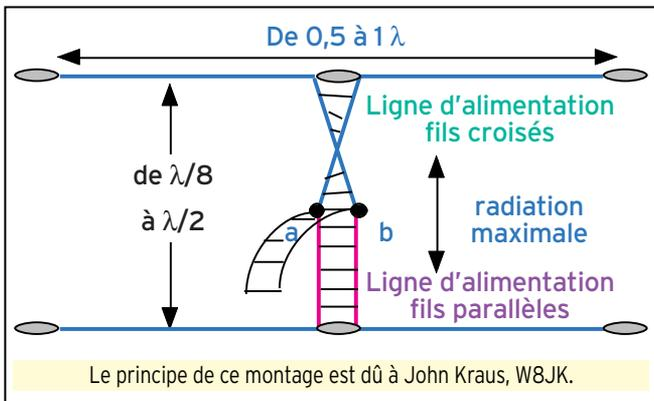
Figure 5 : Vue de dessus d'un montage horizontal.
