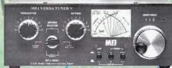
**MFJ 989C** Coupleur 1,8 à 30 MHz, 3000 W. Watt/ROS-mètre à aiguilles croisées 200/2000 W, éclairage cadran 12 Vdc. Self à roulette. 2 sorties coax + 1 sortie long fil + 1 sortie ligne. Charge 300 W incorporée.
