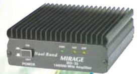
**BD-35 Mirage** Amplificateur linéaire VHF/UHF. Sortie 30 à 45 W (VHF) et 16 à 35 W (UHF) pour 1 à 7 W d'excitation (conçu pour utilisation avec TX portatifs). Sélection automatique de bande. Commutation automatique émission/réception. Fonction full-duplex. Connecteurs uniques en entrée et en sortie pour raccordement d'émetteurs et d'antennes bi-bandes. Protection contre les inversions de polarité.
