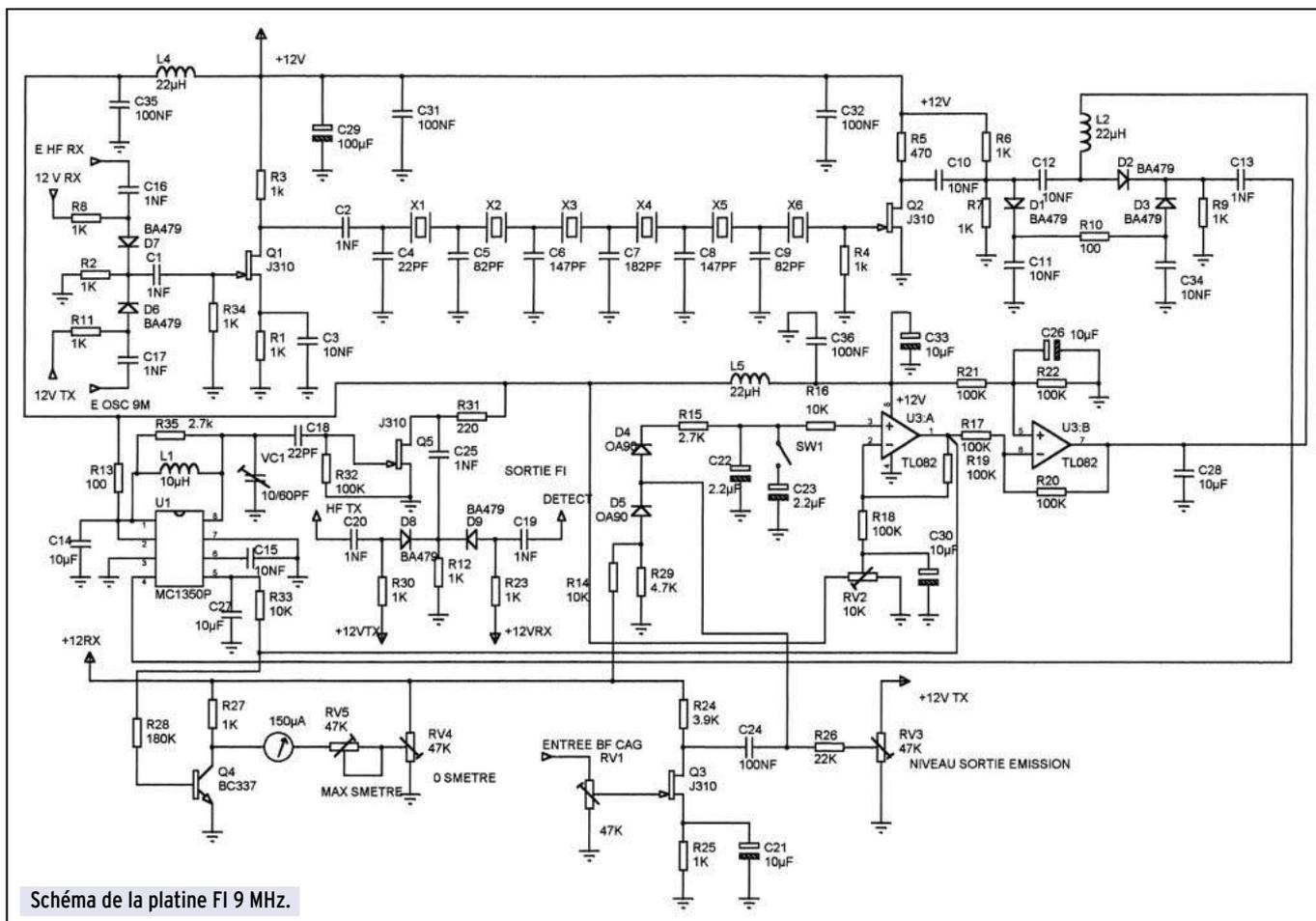
Schéma de la platine FI 9 MHz.
