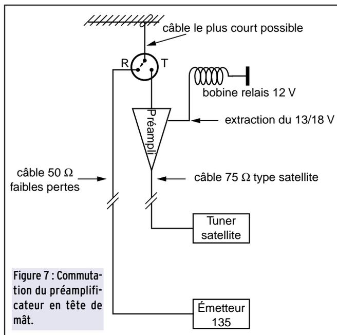
Figure 7 : Commutation du préamplificateur en tête de mât.
