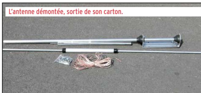
produit à un prix compétitif. Les divers morceaux de tubes sont fendus à une extrémité, celle qui assure la jonction avec un autre tronçon, les deux étant maintenus par des colliers métalliques crantés préposés au serrage. Chaque tube doit pénétrer dans l'autre d'une longueur de 10 cm, comme le précise la
