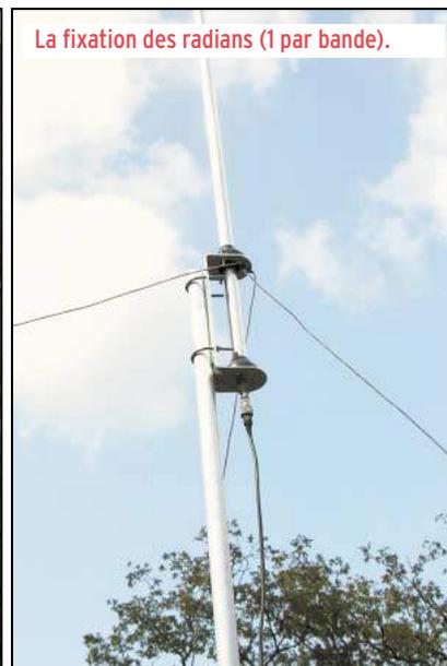
L'antenne GP-3W montée.
