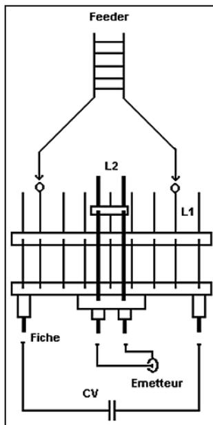
N'oublions surtout pas le dernier élément d'une antenne Lévy, authentique ou dénaturée. Il s'agit bien entendu du système d'accord, de l'adaptateur d'impédances, de la boîte de couplage, du coupleur d'antenne, du "matcher", du "transmatch" (Transmitter to
