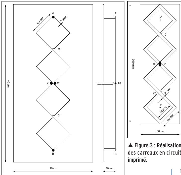
Figure 2 : Antenne quadruple quad devant réflecteur.
