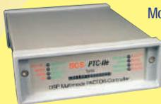
Modes de trafic gérés : PACTOR-II, PACTOR-I, AMTOR, NAVTEX, RTTY, PSK31, PACKET (300/1200/9600 Bauds), SSTV (y compris mode spécial JVCOMM32), FAX, RTTY, AM-FAX (Météosat), CW. Dimensions
