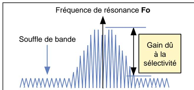
Figure 10 : Réception sur une antenne sélective.
