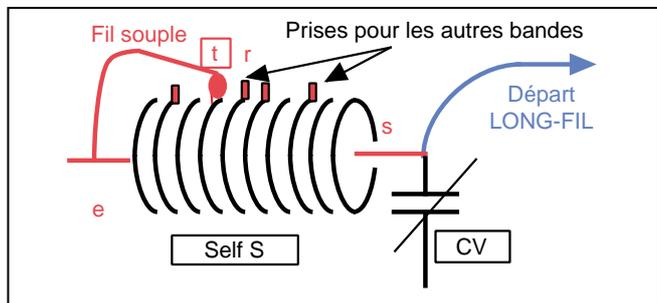
Figure 12 : Self à prises pour long-fil multibande.
