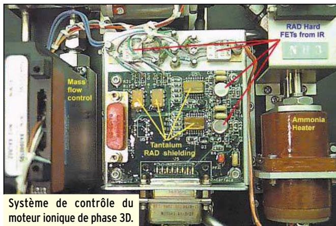
Système de contrôle du moteur ionique de phase 3D.
