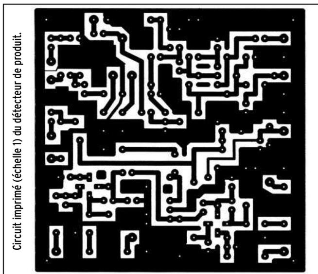
Circuit imprimé (échelle 1) du détecteur de produit.
