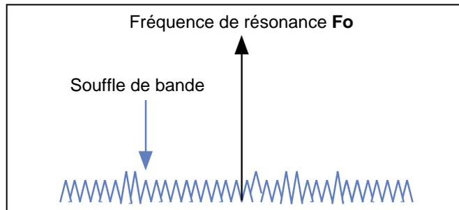
Figure 9 : Réception sur une antenne non sélective.
