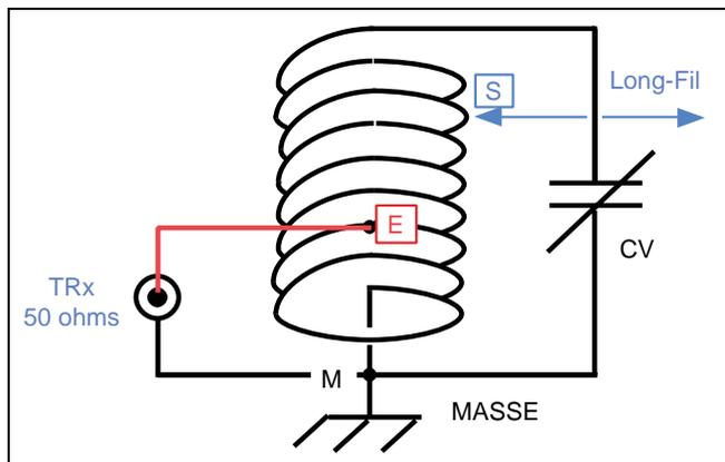
Figure 13 : Coupleur à circuit parallèle pour long-fil.
