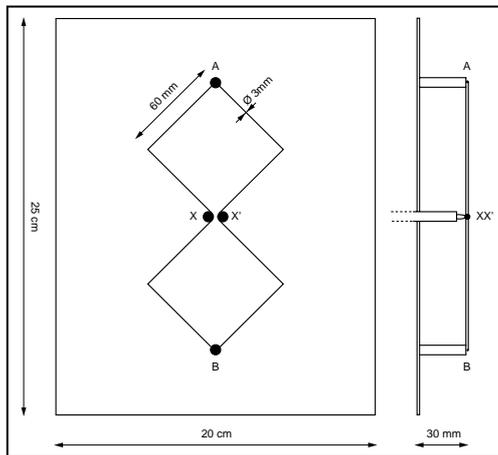
Figure 1 : Antenne double quad devant réflecteur.
