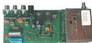
Caractéristiques communes : platines montées et testées, alimentation 13,8V, sorties audio (6,0 et 6,5 MHz modifiables en 5,0 ou 5,5 MHz) et vidéo sur RCA, sortie HF sur SMA femelle, fréquences fixes (1255, 1250, 1285, 1286.5, 1247, 1282.5, 1279.5 MHz).
