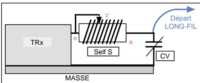
Figure 11 : Boîte d'accord pour l'antenne long-fil.
