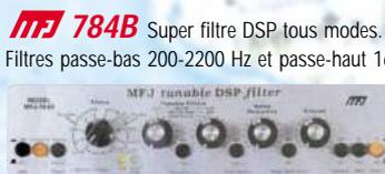
**MFJ 784B** Super filtre DSP tous modes. Filtre notch automatique 50 dB. Réducteur de bruit 20 dB. Filtres passe-bas 200-2200 Hz et passe-haut 1600-3400 Hz réglables. Filtre passe-bande 50-680 Hz avec fréquence centrale 300-3400 Hz. 16 filtres pré-régés reprogrammables par l'utilisateur. Fonction by-pass. Amplificateur BF de contrôle avec sortie haut-parleur externe ou casque. Alimentation 12 Vdc.
