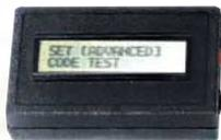
**MFJ 259B** Générateur analysant le ROS de 1,8 à 170 MHz. Fréquence LCD 10 digits + affichage par 2 galvanomètres du ROS et de la résistance HF. Mesure des impédances complexes (résistance et réactance ou amplitude et phase). Prise SO-239. Entrée BNC séparée pour utilisation en fréquencesmètre. Alimentation piles ou adaptateur secteur.
