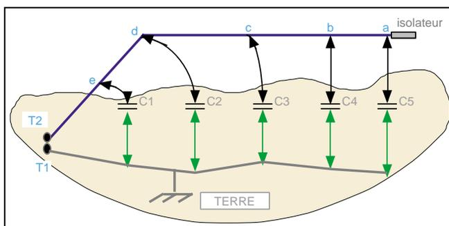
Figure 7 : Comment fonctionne une antenne long-fil..
