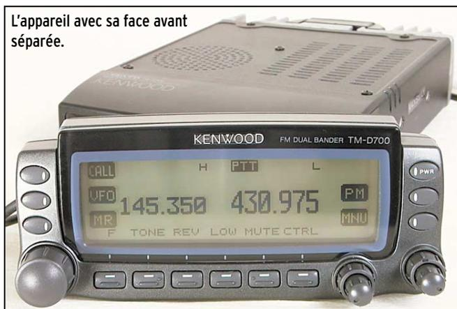
L'appareil avec sa face avant séparée.
