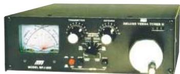
**MFJ 969** Coupleur 1,8 à 54 MHz, 300 W PEP. Watt/ROS-mètre à aiguilles croisées. Self à roulette. Balun interne 4:1. Commutateur antenne à 8 positions. Charge incorporée.
