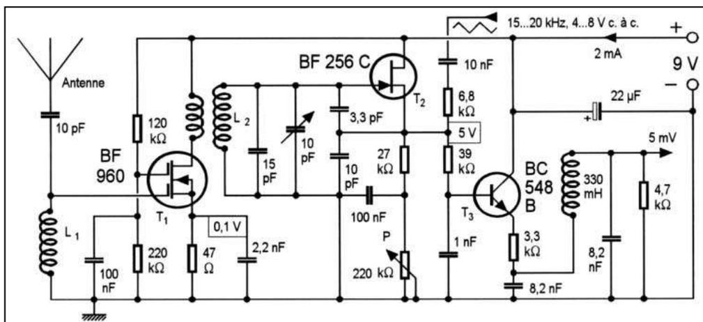
Figure 1 : Récepteur à régénération externe. Les bobinages HF utilisent des mandrins de 8 mm à noyau d'ajustage, L1 comporte 20 spires espacées sur 15 mm, L2 2 spires au primaire, 15 au secondaire, fil de 0,4 mm.
