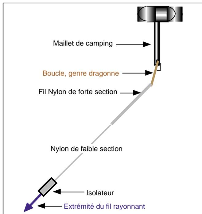
Figure 5 : Le "lanceur" d'antenne.
