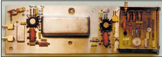
tie du mixer doit être adaptée @ 50 ohms, mais doit pouvoir également se comporter correctement aux signaux produits par les différents mélanges de fréquence. Pour ce faire, un "diplexer" a été utilisé. Son rôle est de rejeter les produits de fréquence indésirables, tout en conservant une impédance constante en sortie du mélangeur. Il est construit autour de deux circuits LC parallèle / série. Par ailleurs, les pertes d'insertion de l'ordre de 6 dB sont com-
