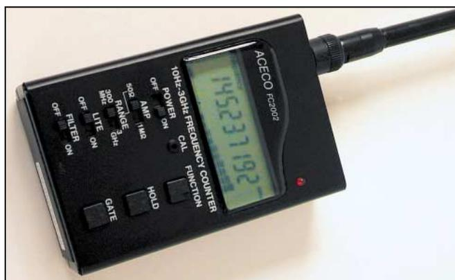
sur les modules COMTECH, délivrant 10 mW sur 2,3 GHz, nous avons obtenu de meilleurs résultats avec un simple bout de fil de 5 cm qu'avec l'antenne. Les commandes de l'appareil se résument à 5 commutateurs à glissière et 3 boutons poussoirs.
