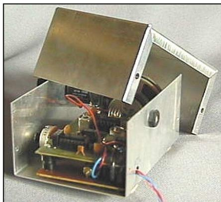
Photo 2 - Petit boîtier en tôle d'aluminium pliée.
