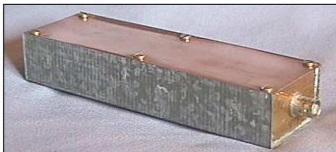
Photo 1 - Boîtier formé d'un U en tôle galvanisée.
