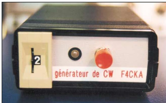
Le boîtier vu côté face avant, avec de gauche à droite : la roue codeuse, la LED témoin et la commande d'envoi de message.
