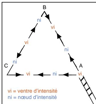
Figure 5 : Delta-Loop de 83 m oscillant sur la bande des 40 m.
