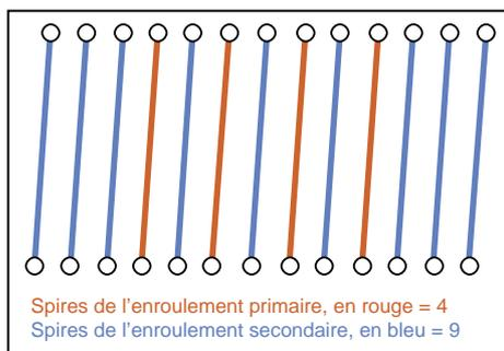
Figure 8 : Bobinage "Chambord".
