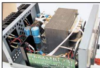
un bon vieux transformateur à l'intérieur et le ballast est constitué d'un groupement de quatre 2N3055 en parallèle. La régulation est confiée à un MC723. Un thyristor entre en action si la tension dépasse 16V, provoquant ainsi la coupure de l'alimentation. Dans la même gamme, il existe un modèle (D-PS-1225GWM) disposant de toutes les protections nécessaires en courant, tension et température. Ainsi, si la température dépas-
