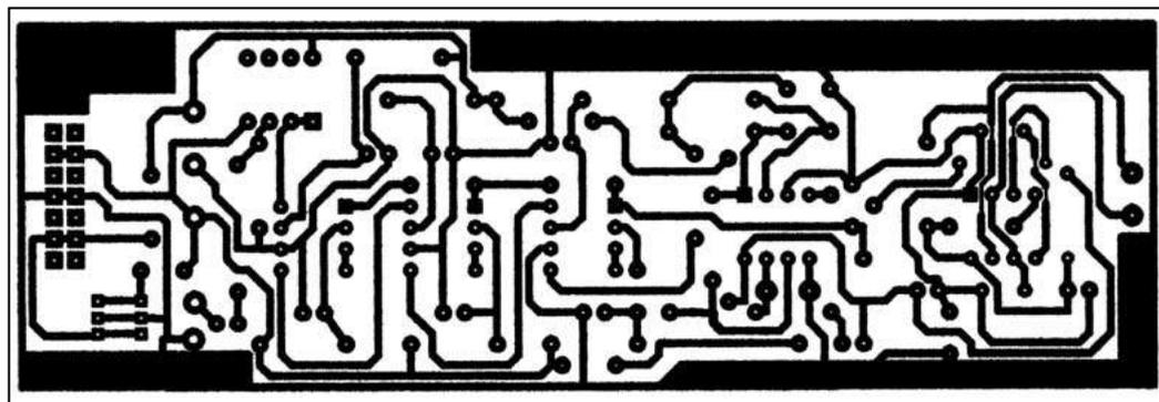
Circuit imprimé du filtre passe-bas à l'échelle 1.
