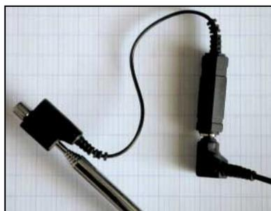
Un clips pour les récepteurs sans prise antenne.
