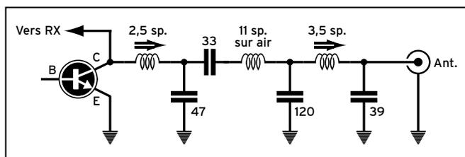
Les bobines surmontées d'une flèche sont les mandrins à noyau d'origine du TX. La self à air fait 11 tours sur un diamètre de 6 mm. (Il y a peut-être mieux mais, ainsi, ça marche du premier coup).
