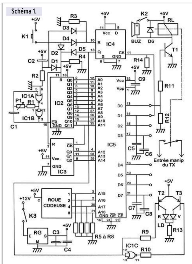
quand un front descendant apparaît en Q11). Cette mise en cascade permet d'obtenir un pseudo compteur binaire 15 étages et 15 sorties.
