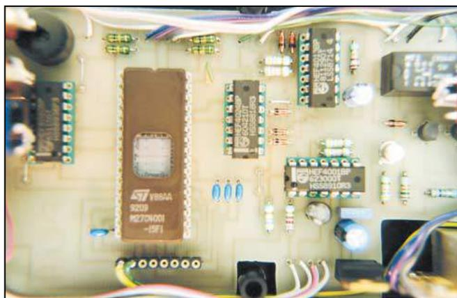
Vue de détail de l'EPROM. Il n'est pas obligatoire de placer une étiquette sur la fenêtre, le boîtier du générateur la protégeant des U.V.
