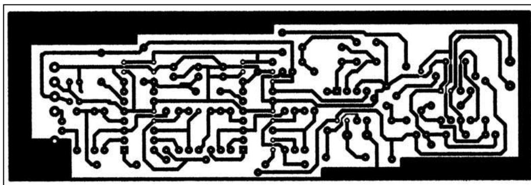
Circuit imprimé du filtre passe-haut à l'échelle 1.
