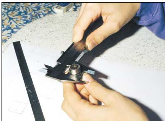
Photo 2 - Déterminer le diamètre des trous à percer.
