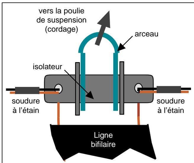
Figure 6 : Arrivée de l'alimentation de la Delta-Loop.
