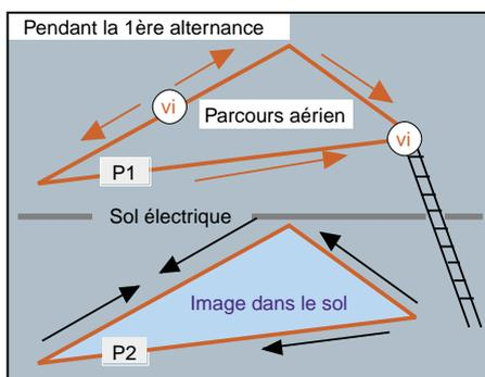
Figure 1 : Vue en perspective de la Delta-Loop.
