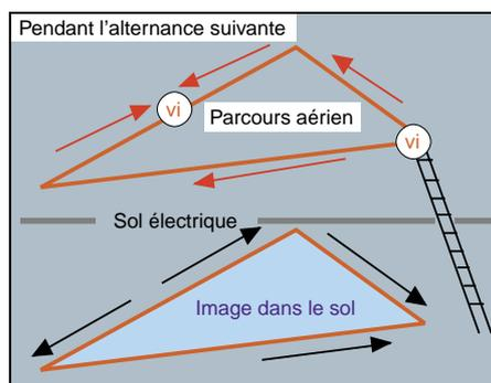
Figure 2 : Vue en perspective de la Delta-Loop.
