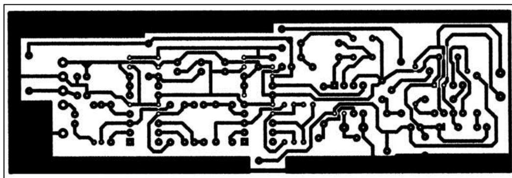
Circuit imprimé du filtre notch à l'échelle 1.
