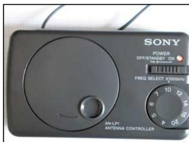
Le boîtier de commande de l'antenne.
