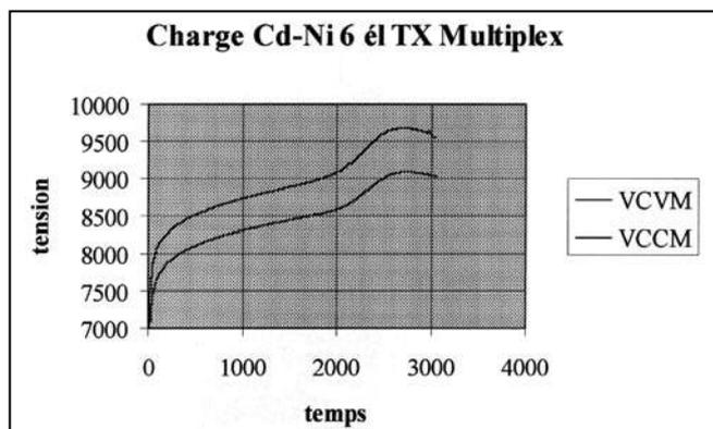
Figure 1 : Courbes de charges d'une batterie de 6 éléments.
