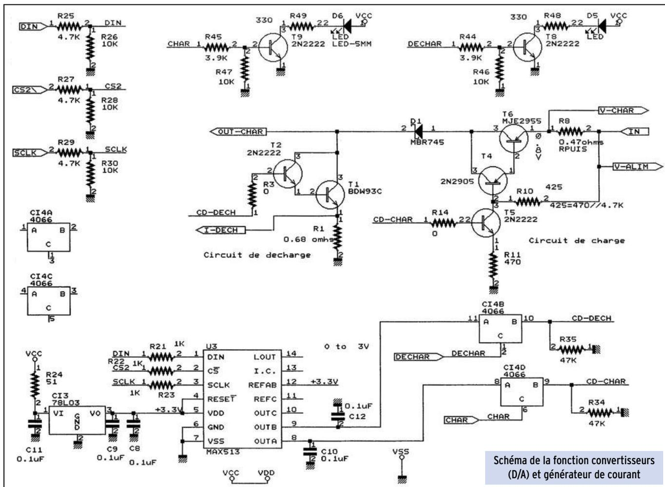
Schéma de la fonction convertisseurs (D/A) et générateur de courant
