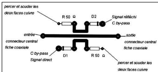
Figure 4 : ROS/milliwattmètre 1.255 GHz. Composants côté pistes.
