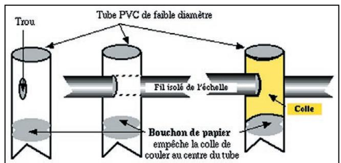
Figure L07 - Ecarteur de ligne d'alimentation en tube PVC.
