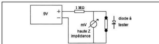
Figure 5 : Test pour sélection des diodes. La tension aux bornes des diodes doit être identique à quelques mV près.
