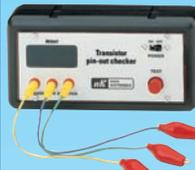
Ce kit va vous permettre de repérer les broches E, B, C d'un transistor et de savoir si c'est un NPN ou un PNP. Si celui-ci est défectueux vous lirez sur l'afficheur "bAd".
