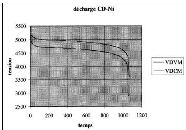
Figure 2 : Courbes de décharge d'une batterie de 4 éléments.
