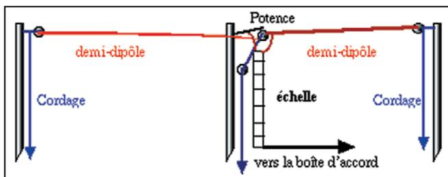
Figure L01 - Configuration d'une Lévy avec mâts central et terminaux.
