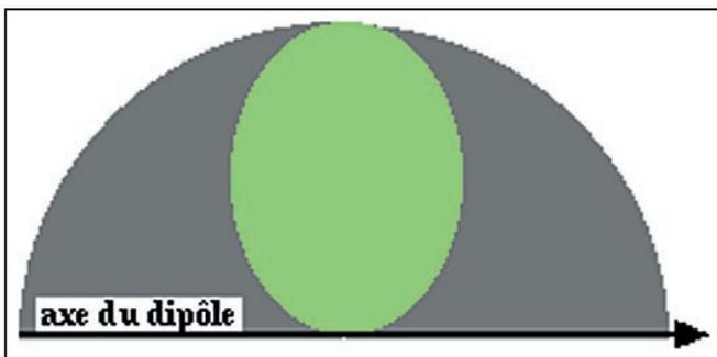
Figure L09 - Rayonnement vertical, dans le plan du fil.
