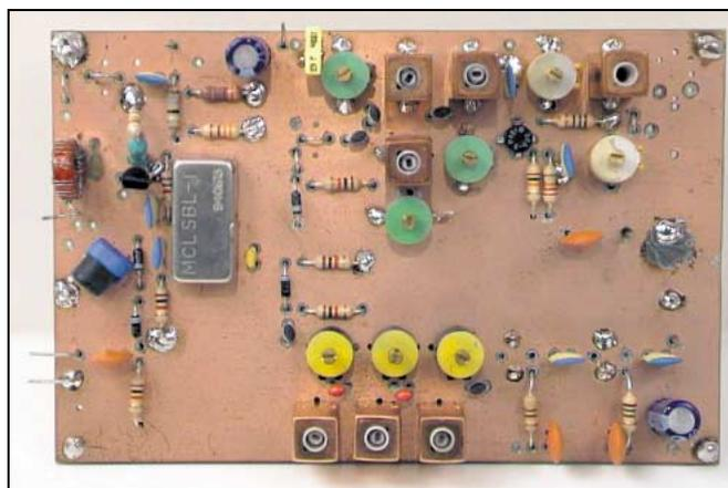
Côté HF, la commutation émission-réception se fait par l'intermédiaire de deux diodes PIN, D2 et D3. Le 12 V émission fait conduire D3 et bloque D2.
