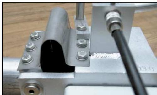
Jonctions mécaniques électriquement soignées.
