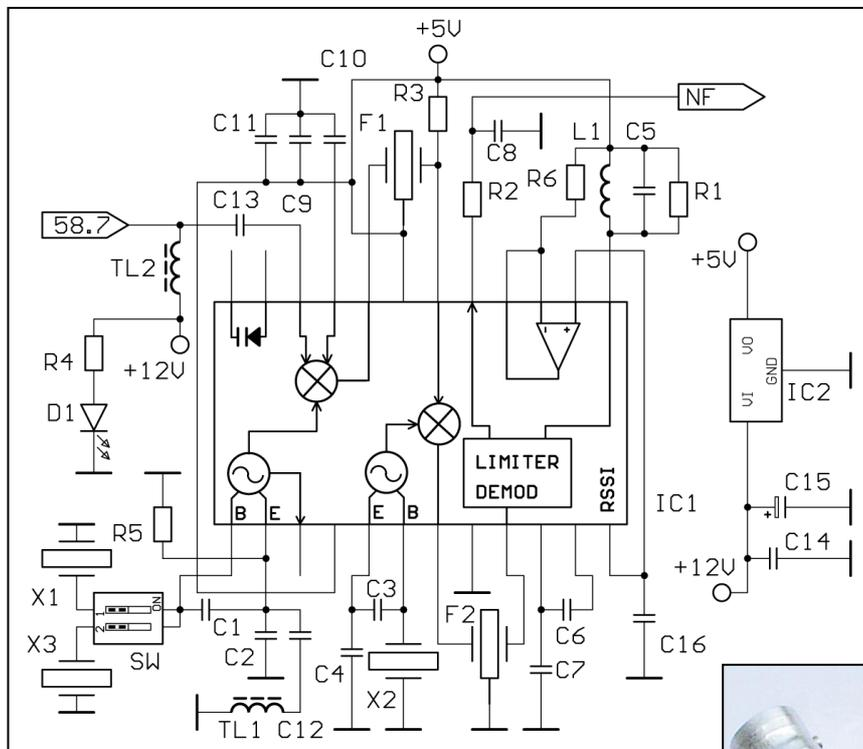
Figure 17 - Schéma du récepteur.
