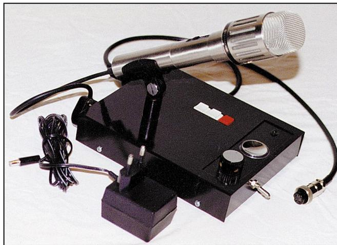
tateur 230V / 24VDC est tout aussi possible (attention à la polarité). Sur la basse tension, un jack d'alimentation assurera la liaison avec le circuit. Pas de difficulté pour exécuter le bobinage L1 (voir le dessin & 4.2.1) cela permet de supprimer les courants HF, qui circulent dans la station et les parasites éventuels du réseau électrique.
