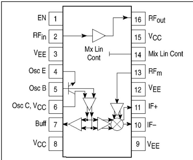
Figure 13 - Schéma de principe du CI MC13142.
