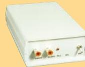
Ce petit émetteur permet de retransmettre une image vidéo ainsi que le son sur une télévision déportée. La télésurveillance est une application idéale. Puissance HF : 50 mW env. Portée : 200 m env. Standard émission : CCIR sous-porteuse son 5,5 MHz. Fréquence émission : (canaux UHF 30 à 39). Consommation : 180 - 200 mA. Alimentation : 4 piles de 1.5 V max.
