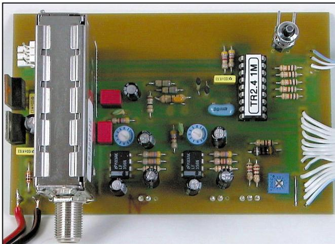
nécessitant un outil spécial pour leur sertissage. Pour cette raison, la nappe a été directement soudée sur le circuit imprimé. Dans les kits qui seront prochainement distribués, des connecteurs plus simples à utiliser seront proposés. Les circuits imprimés
