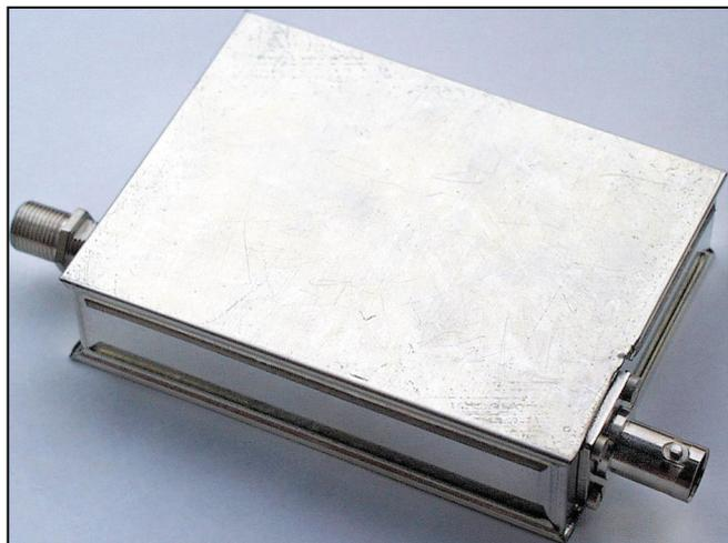
se résume à une bande passante de 0 à 1800 MHz à la fois pour la HF, l'oscillateur local et la FI, avec un facteur de bruit de 1,8 dB et gain de 17 dB pour l'étage HF et un gain de 9 dB pour le mélangeur.
