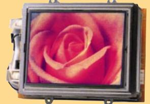
Système de fonctionnement : Pal. Principe de fonctionnement : TFT à matrice active. Dimension de l'affichage : 10 cm (4"). Nombre de pixels : 89622. Résolution : 383 (l) x 234 (L). Configuration pixels : RVB Delta. Rétro-éclairage : CCFT. Signal vidéo d'entrée : 1 Vpp / 75 Ω. Tension d'alimentation : 12 VDC. Consommation : 7 watts. Dimensions : 122 (l) x 36 (P) x 84 (H) mm. Température de travail : - 5 °C à + 40 °C. Durée garantie : 10 000 heures.
