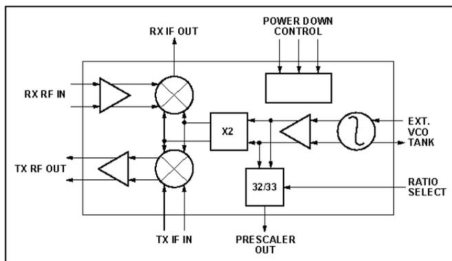
Figure 3 - Diagramme schématique du CI HPMX-5001.
