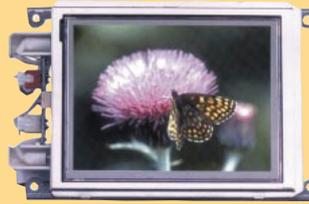
Système de fonctionnement : Pal. Principe de fonctionnement : TFT à matrice active. Dimension de l'affichage : 10 cm (4"). Nombre de pixels : 112320. Résolution : 480 (l) x 234 (L). Configuration pixels : RVB Delta. Rétro-éclairage : CCFT. Signal vidéo d'entrée : 1 Vpp / 75 Ω. Tension d'alimentation : 12 VDC. Consommation : 7 watts. Dimensions : 122 (l) x 36 (P) x 84 (H) mm. Température de travail : - 5 °C à + 40 °C. Durée garantie : 10 000 heures.
