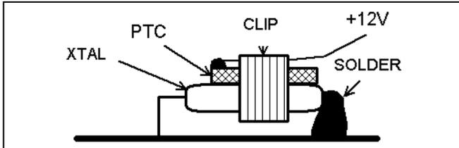
Figure 12 - Montage de la thermistance CTP sur le quartz de référence du convertisseur.
