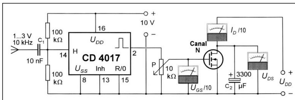
Figure 1 : Une décade de comptage fournit des impulsions d'un rapport cyclique de 0,1 à l'électrode de commande de l'échantillon mesuré.
