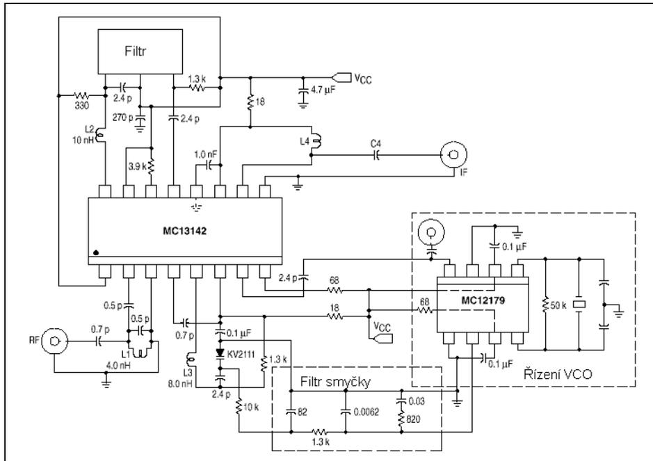
Figure 15 - Convertisseur abaisseur pour la bande 1,9 GHz.
