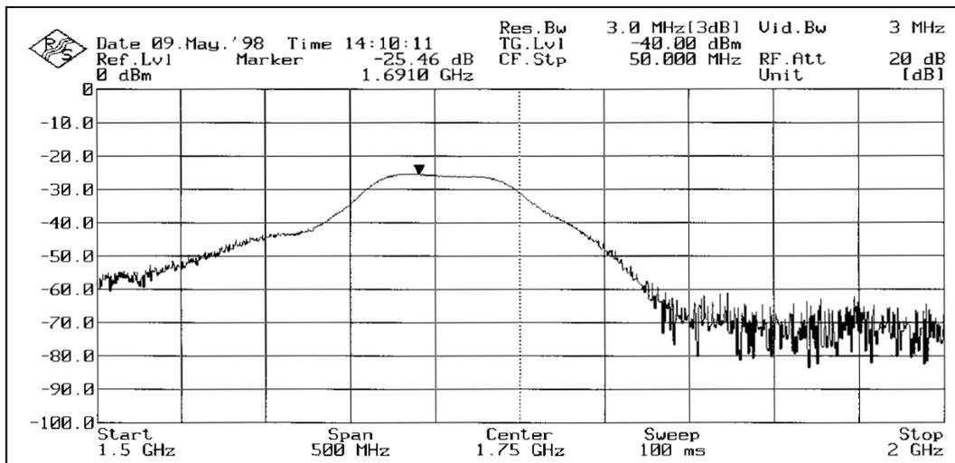
Figure 5 - Caractéristiques mesurées du filtre 1691 MHz.
