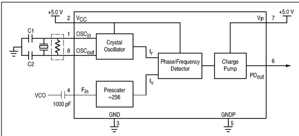
Figure 14 - Un synthétiseur simple avec le CI MC12179.
