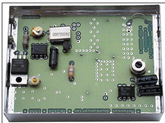
diminue ou augmente. Le PLL doit rester verrouillé sur une plage de tensions comprises entre 3 et 9 volts. Réglez donc C18 pour obtenir une valeur optimale U<sub>lad</sub> = 4,5 volts. En coupant et rétablissant l'alimentation, le PLL doit maintenant se verrouiller sans problème, sinon rajustez légèrement C18 pour obtenir une tension U<sub>lad</sub> optimale (U<sub>lad</sub> doit être comprise entre 4 et 5 volts).
