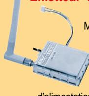
Module émetteur audio/vidéo offrant la possibilité (à l'aide d'un cavalier) de travailler sur 4 fréquences différentes (2,400 - 2,427 - 2,457 - 2,481 GHz). Puissance de sortie 10 mW sous 50 Ω, entrée audio 2 Vpp max. Tension d'alimentation 12 Vcc. Livré avec une antenne accordée.
