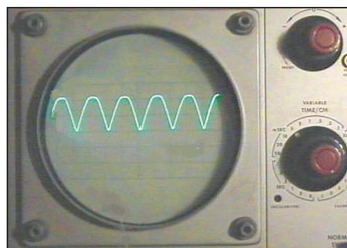
Photo 3 - La tension redressée derrière les diodes.
