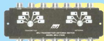
**MFJ-1700B** Commutateur céramique 2 x 6 directions 30 MHz, 2 kW PEP. Toutes combinaisons entre 6 antennes et 6 transceivers, avec possibilité d'intercaler coupleur, wattmètre, linéaire... Entrées non utilisées mises à la masse. 50-75 ohms. Prises SO-239.
