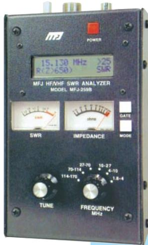
**MFJ-259B** Générateur analysant le ROS de 1,8 à 170 MHz. Fréquencemètre LCD 10 digits + affichage par 2 galvanomètres du ROS et de la résistance HF. Mesure des impédances complexes (résistance et réactance ou amplitude et phase). Prise SO-239. Entrée BNC séparée pour utilisation en fréquencemètre. Alimentation piles ou adaptateur secteur.
