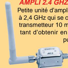
Petite unité d'amplification HF à 2,4 GHz qui se connecte au transmetteur 10 mW permettant d'obtenir en sortie une puissance de 50 mW sous 50 Ω. L'amplificateur est alimenté en 12 V et il est livré avec son antenne.
