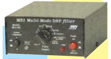
**MFJ-781** Filtre DSP multi-modes. Sélection en face avant par bouton rotatif de 20 filtres choisis parmi 64 filtres data, 32 filtres CW, 4 filtres optimisés pour packet VHF, Clover, Wefax et SSTV. Contrôle des niveaux d'entrée et de sortie. Fonction By-pass. Fonction auto-test. Se branche à la sortie audio du récepteur. Alimentation 10 à 16 Vdc.
