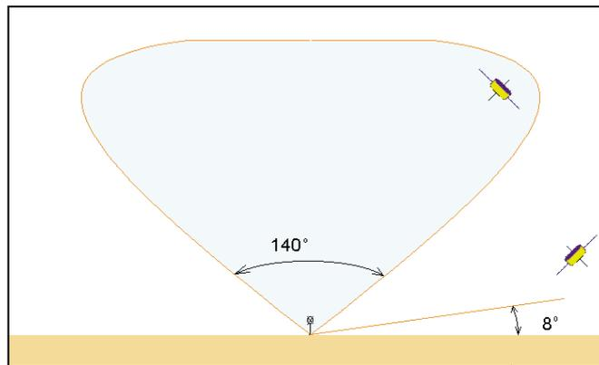
Figure 11 : Lobe de rayonnement de l'antenne Hélice Quadrifilaire.
