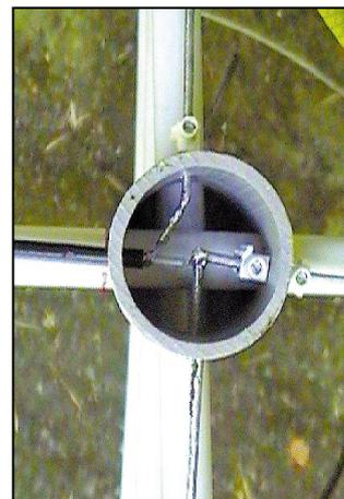
Figure 7 : Connexions du haut de l'antenne (vue de dessus). La moitié de la grande boucle est obligatoirement réalisée en coax. Les trois autres brins peuvent être en coax court-circuité ou en fil métallique.
