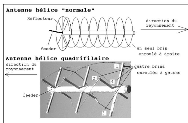
Figure 1 : L'antenne hélice comparée avec l'antenne hélice quadrifilaire.
