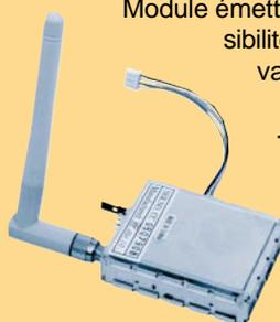
Module émetteur audio/vidéo offrant la possibilité (à l'aide d'un cavalier) de travailler sur 4 fréquences différentes (2,400 - 2,427 - 2,457 - 2,481 GHz). Puissance de sortie 10 mW sous 50 Ω, entrée audio 2 Vpp max. Tension d'alimentation 12 Vcc. Livré avec une antenne accordée.
