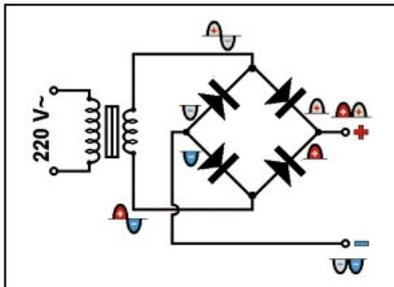
Figure 9 - Pont de redressement à 4 diodes.
