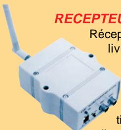
Récepteur audio/vidéo livré complet avec boîtier et antenne. Il dispose de 4 canaux sélectionnables à l'aide d'un cavalier.
