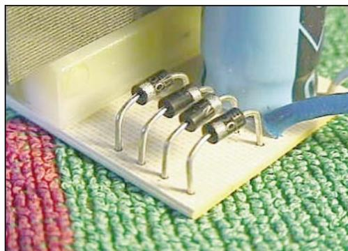
Photo 1 - Quatre diodes pour redresser le courant.
