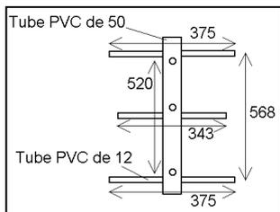
Figure 8 : Cotes de l'armature en millimètres. Les dimensions des bras latéraux indiquent où les spires doivent passer. Les tubes doivent en réalité être un peu plus longs. On les perce ensuite là où ils vont être traversés par les brins.
