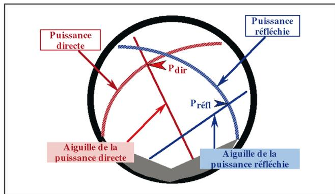
Figure 6h - TOS-mètre à aiguilles croisées (cadran simplifié).
