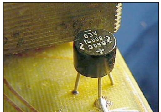
Photo 2 - Quatre diodes dans un même boîtier.
