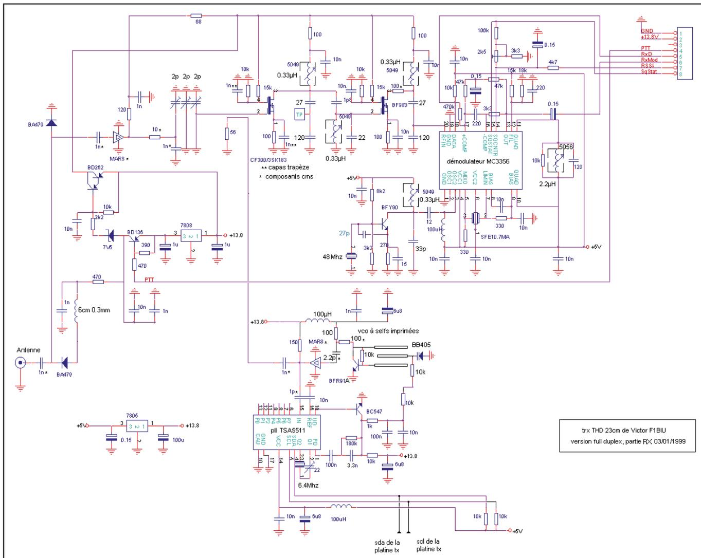
fret, de manière à ce que la HF soit canalisée via l'antenne et le préampli MAR8. Si le kit RX n'est pas en coffret, c'est le mélangeur CF300 qui reçoit directement la porteuse, les capas n'ont plus d'effet.
