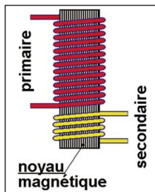
Figure 2 - Deux bobines couplées = un transformateur.
