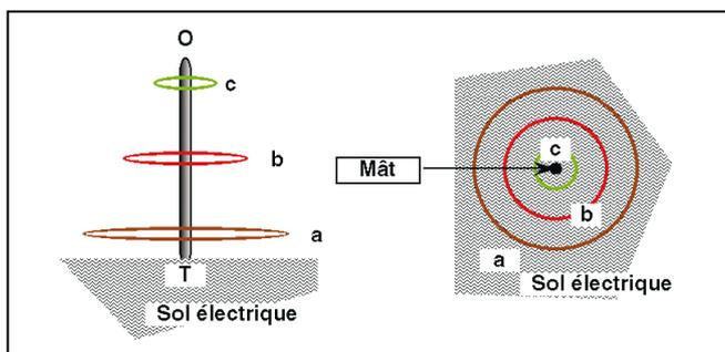
Figure 1 - Rayonnements d'une antenne quart d'onde verticale.
