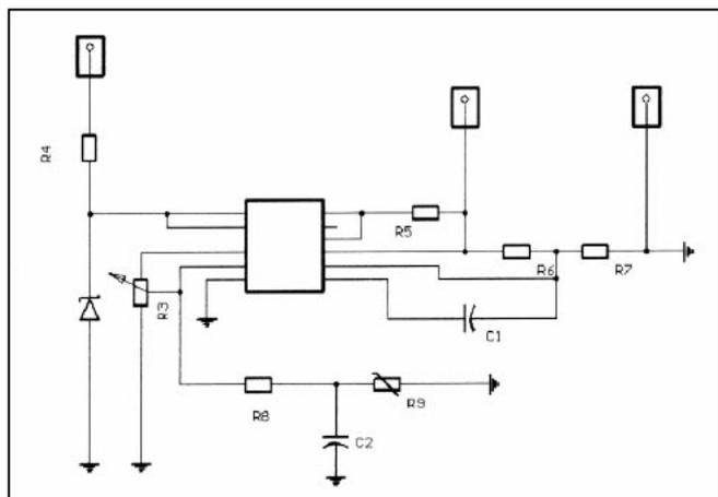
Le choix de l'emplacement de la thermistance est fonction de la constante thermique recherchée. La pente est réglable lors des essais par le choix judicieux de R6 (valeur à déterminer par expérimentation cf. : paragraphe « trucs et astuces »). La polarisation peut être supprimée en mettant R11 à la masse. D1, R5, servent à limiter la tension qui alimente le MC1723 à une valeur compatible avec ses spécifications (28V).
