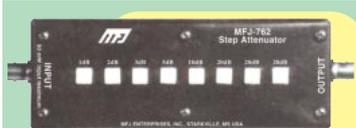
**MFJ-762** Atténuateur 81 dB par pas de 1 dB. Fréquence typique jusqu'à 170 MHz (utilisable jusqu'à 500 MHz). Entrée 250 mW max. Impédance 50 ohms. Technologie CMS sur circuit stripline. Utilisation en entrée récepteur et mesure. Prises entrée/sortie BNC (livré avec deux adaptateurs BNC/SO-239).
