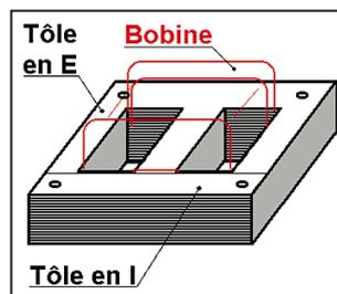
Figure 4 - La bobine et le circuit magnétique.
