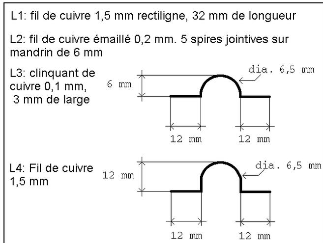
Figure 5 : Dimensions et formes des selfs du PA.
