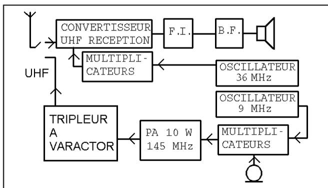
Figure 1 : Schéma général du KF 450.
