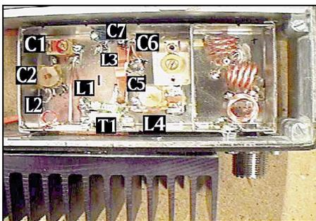
Photo 7 : Le PA en place dans le KF 450. Notez le radiateur à l'extérieur du transceiver, le filtre passe-bas dans le même boîtier blindé que le PA, et la seconde prise SO-239 qui sert de sortie VHF.
