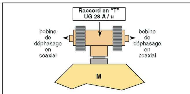
Figure 6 - Exemple de montage d'un "T".
