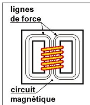
Figure 3 - Le circuit magnétique d'un transfo.
