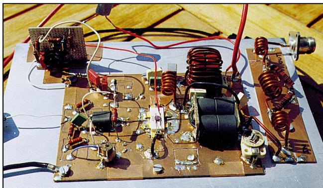
**Cet article décrit un amplificateur linéaire de puissance utilisant un transistor MOS-FET RF, type MRF 151G, de chez MOTOROLA.**
