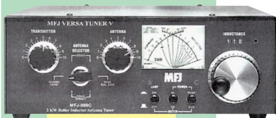
**MFJ-989C** Coupleur 1,8 à 30 MHz, 3000 W. Watt/ROS-mètre à aiguilles croisées 200/2000 W, éclairage cadran 12 Vdc. Self à roulette. 2 sorties coax + 1 sortie long fil + 1 sortie ligne. Charge 300 W incorporée.
