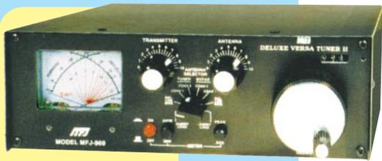
**MFJ-969** Coupleur 1,8 à 54 MHz, 300 W PEP. Watt/ROS-mètre à aiguilles croisées. Self à roulette. Balun interne 4:1. Commutateur antenne à 8 positions. Charge incorporée. Prises SO-239.
