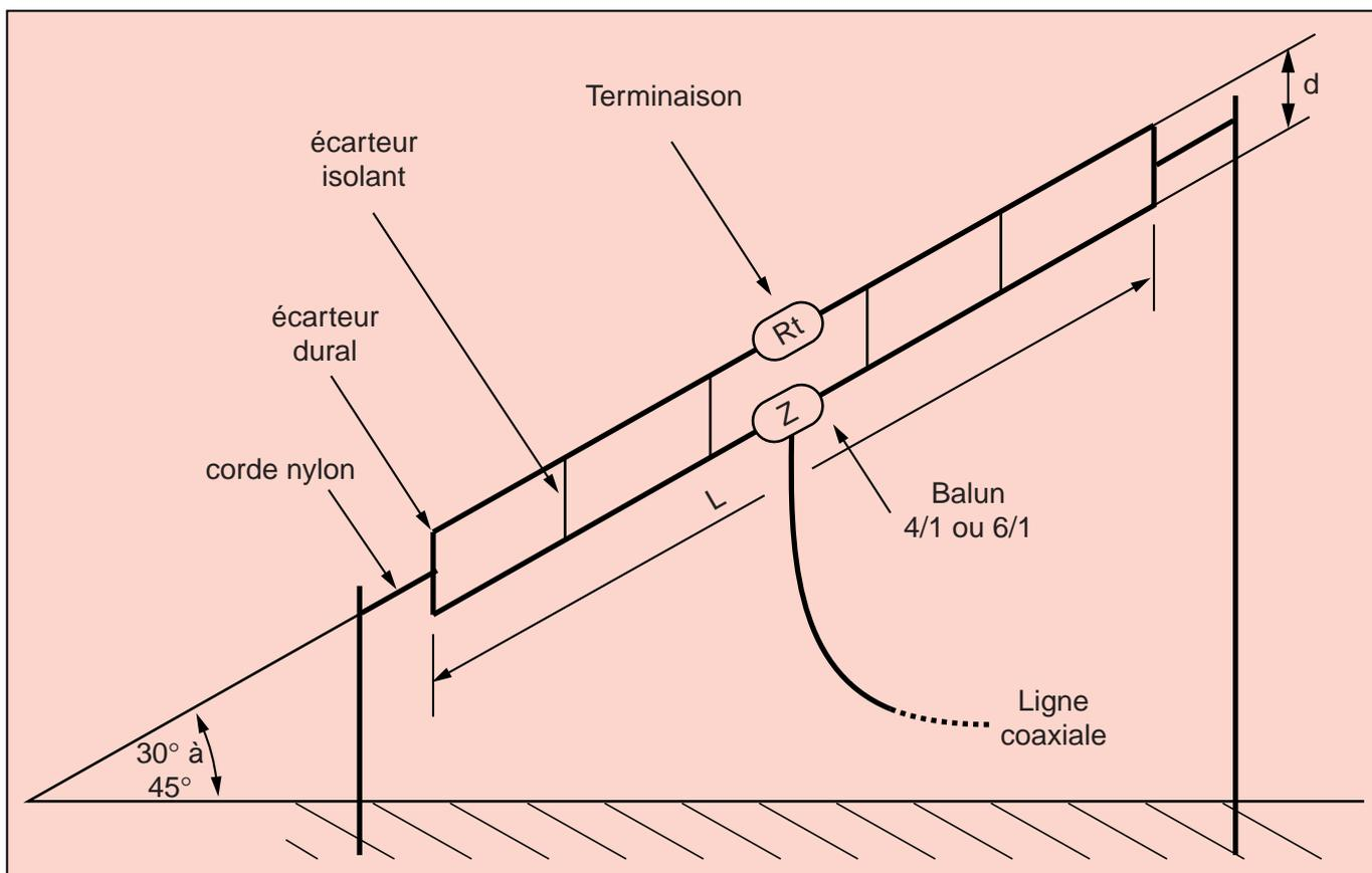
Correctement installée, l'antenne TTFD a un diagramme de rayonnement omnidirectionnel sur la majeure partie de sa bande passante.
