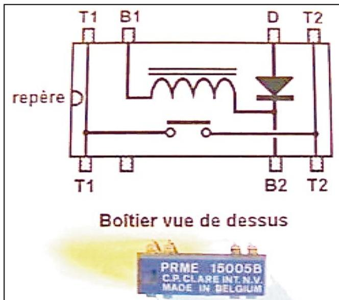
Figure 5 - Exemple de brochage d'un petit relais.
