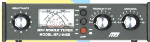
**MFJ-945E** Coupleur 1,8 à 60 MHz, 300 W. Watt/ROS-mètre à aiguilles croisées 30/300 W. Fonction by-pass du coupleur permettant l'utilisation de la fonction watt/ROS-mètre. Eclairage cadran avec alimentation 12 Vdc externe.
