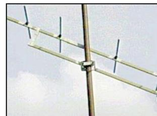
Antenne Yagi levée à 45°.
