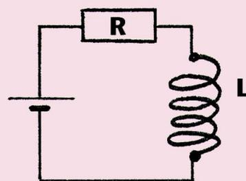
Figure 17 : Etablissement du courant dans une inductance.
