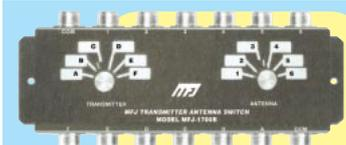
**MFJ-1700B** Commutateur céramique 2 x 6 directions 30 MHz, 2 kW PEP. Toutes combinaisons entre 6 antennes et 6 transceivers, avec possibilité d'intercaler coupleur, wattmètre, linéaire... Entrées non utilisées mises à la masse. 50-75 ohms. Prises SO-239.
