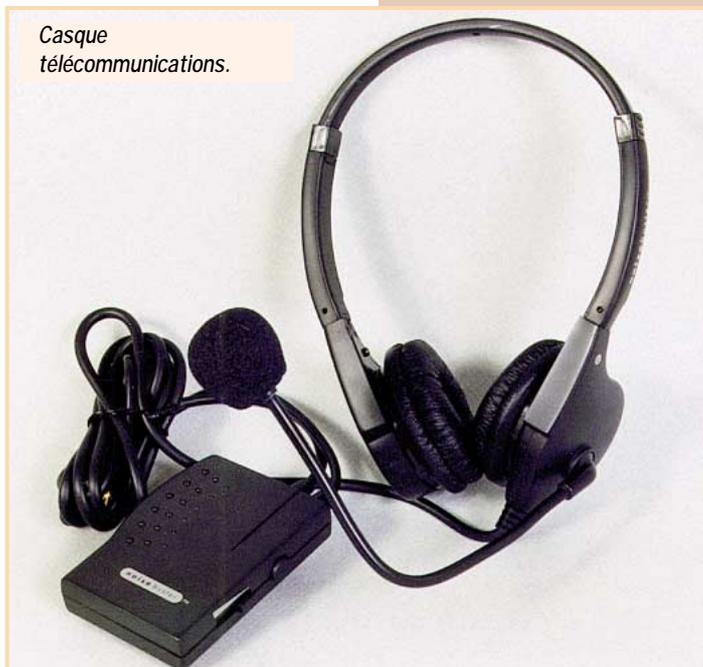
autonomie d'environ 100 heures. Ce boîtier électronique, muni d'un clips de fixation à la ceinture, pris sur le cordon du casque, n'est ni lourd, ni encombrant. Les oreillettes de ces casques peuvent être repliées (mouvement de 90°) pour faciliter un rangement à plat.
