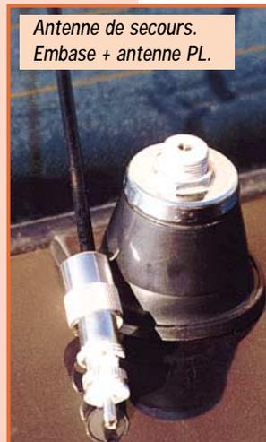
Antenne de secours. Embase + antenne PL.
