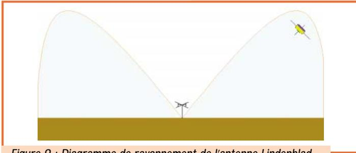
Figure 9 : Diagramme de rayonnement de l'antenne Lindenblad.
