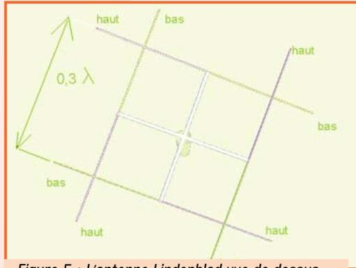
Figure 5 : L'antenne Lindenblad vue de dessus.
