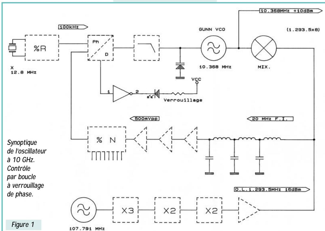
*Synoptique de l'oscillateur à 10 GHz. Contrôle par boucle à verrouillage de phase.*
