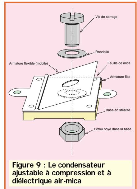
Figure 9 : Le condensateur ajustable à compression et à diélectrique air-mica
