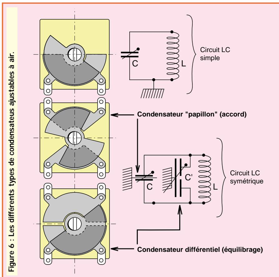
Figure 6 : Les différents types de condensateurs ajustables à air.
