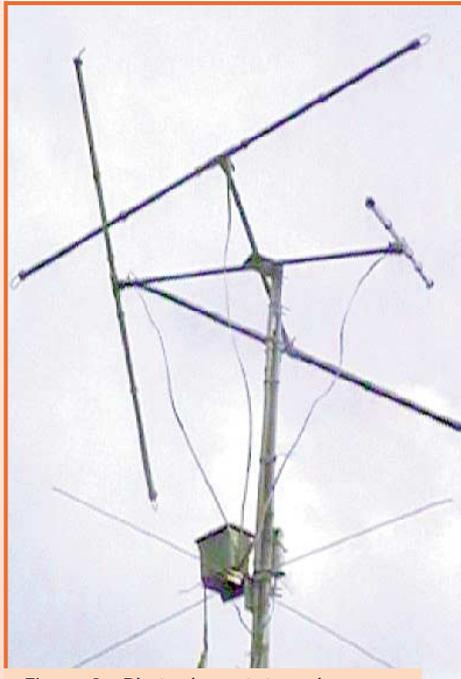
Figure 8 : Photo du prototype de l'antenne Lindenblad.
