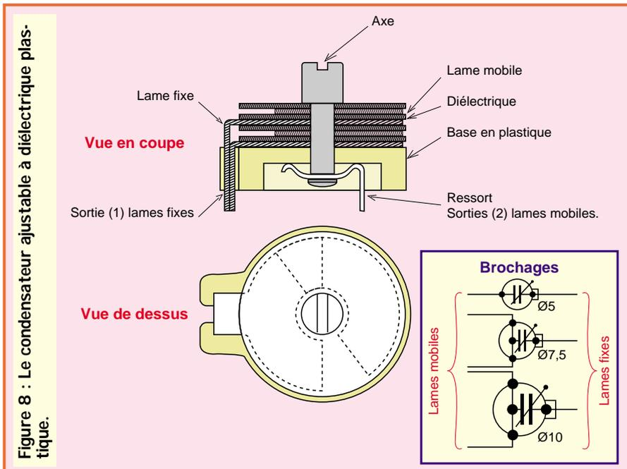
Figure 8 : Le condensateur ajustable à diélectrique plastique.
