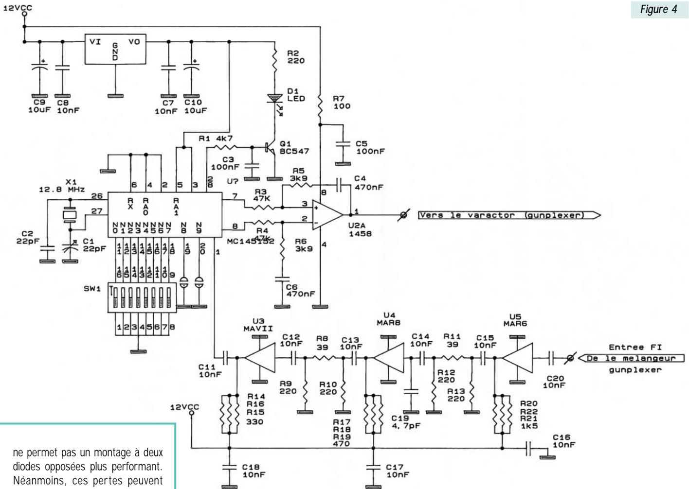
ne permet pas un montage à deux diodes opposées plus performant. Néanmoins, ces pertes peuvent être compensées à faible prix par des circuits intégrés monolithiques (MMIC) facilement disponibles de nos jours. Nous disposons ainsi d'un signal de fréquence intermédiaire comprise entre 300 kHz et 20 MHz à la sortie du mélangeur à cavité. Celui-ci
