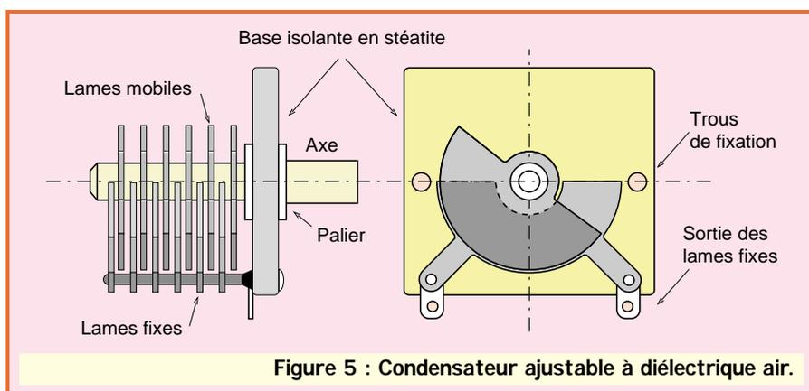
Figure 5 : Condensateur ajustable à diélectrique air.
