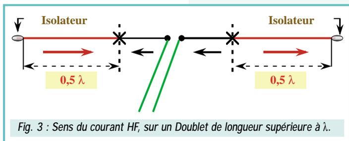
Fig. 3 : Sens du courant HF, sur un Doublet de longueur supérieure à λ.
