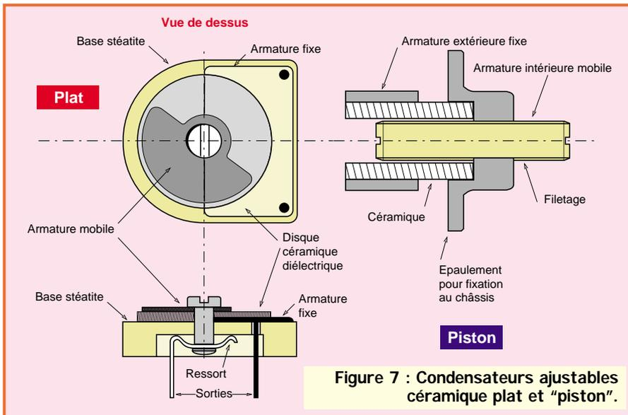
Figure 7 : Condensateurs ajustables céramique plat et "piston".
