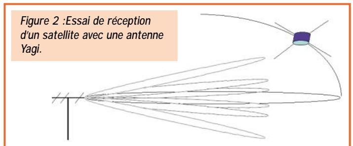
Figure 2 : Essai de réception d'un satellite avec une antenne Yagi.
