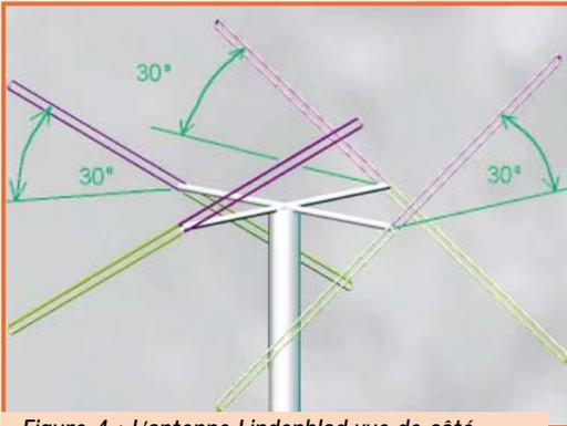
Figure 4 : L'antenne Lindenblad vue de côté.
