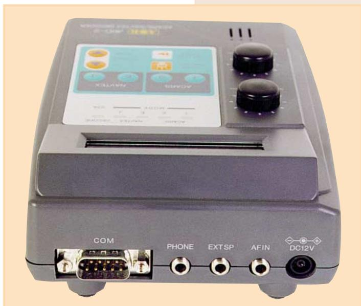
Le niveau BF à injecter n'est pas critique, et le décodage est très fiable sur une large plage du potentiomètre LEVEL. Toutefois, on remarquera quelques données erronées en mode ACARS 1 (checksum invalidée?).
