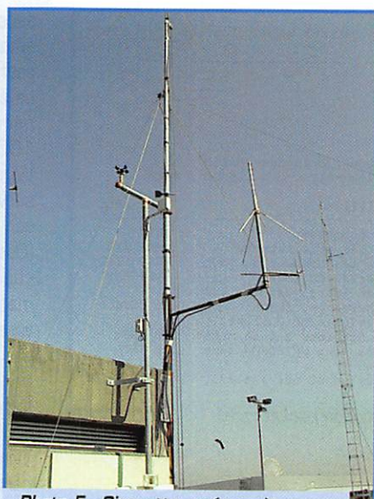
Photo 5 - Girouette, anémomètre, pluviomètre et antennes packet-radio.
