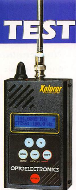
Capteur d'émissions FM proches. **XPLORER**
