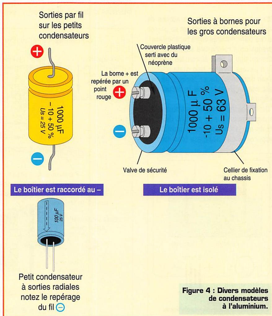
Figure 4 : Divers modèles de condensateurs à l'aluminium.
