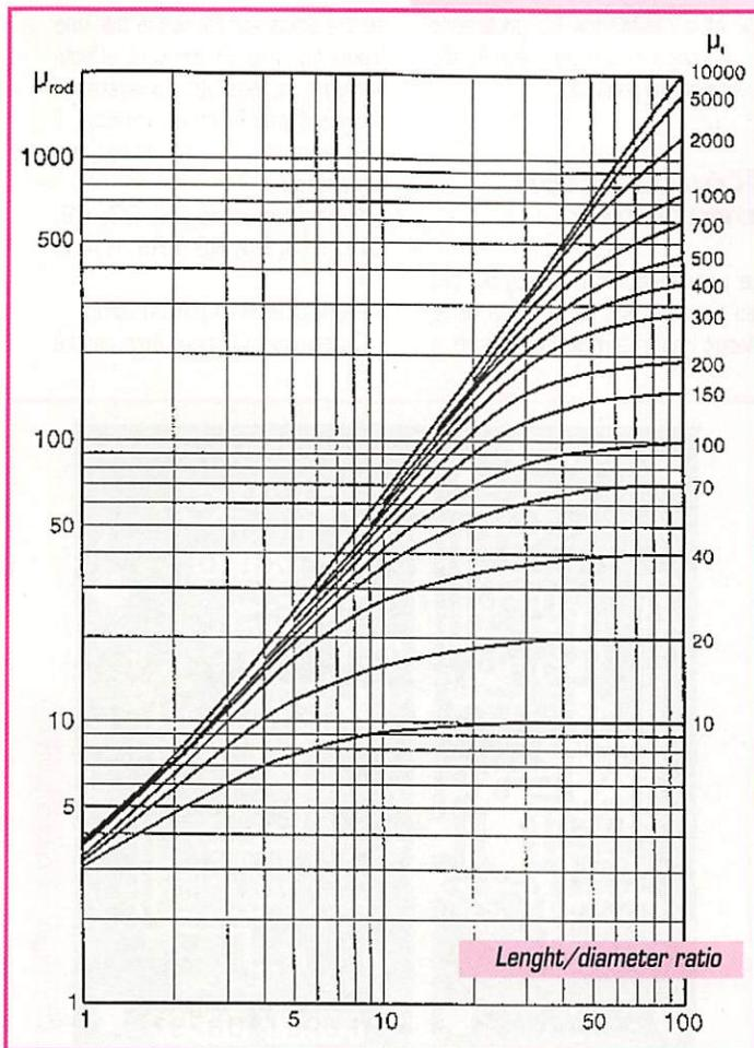
des tores. La perméabilité réelle du noyau d'une antenne ferrite dépend du rapport longueur / diamètre et de la perméabilité  $\mu_i$  donné par le fabricant.
