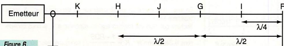
près), la tension résultante en D sera toujours nulle (c'est un nœud de tension, et un ventre de courant). Il en est de même pour le point E ( $U_R$  a pourcouru en effet 2 fois  $\frac{\lambda}{4}$ ). Ce sera également le cas pour tous
