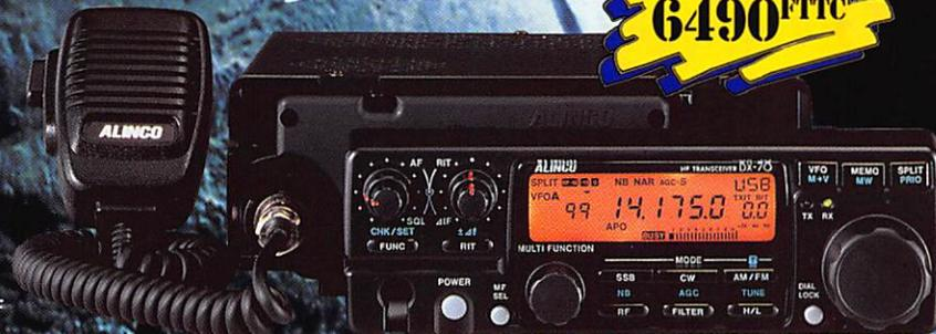
Modes USB, LSB, CW, AM et FM - Dimensions / Poids 178 x 58 x 228 mm / 2.7 kg - Face avant détachable Puissance : 100 W en HF, 10 W en 50 MHz - Filtre sélectif à bande passante étroite en BLU - Filtre sélectif en CW (Morse) - 100 canaux mémoires - Compresseur de modulation - Sortie relais - Packet 1200 Bps
