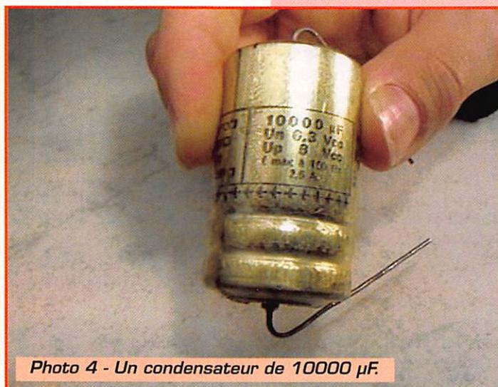
Photo 4 - Un condensateur de 10000  $\mu\text{F}$ .
