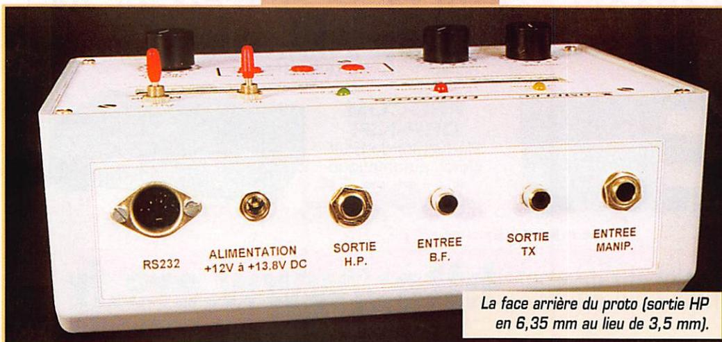
La face arrière du proto (sortie HP en 6,35 mm au lieu de 3,5 mm).
