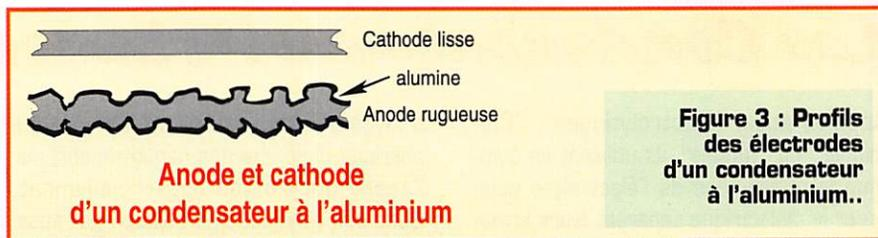
Figure 3 : Profils des électrodes d'un condensateur à l'aluminium..
