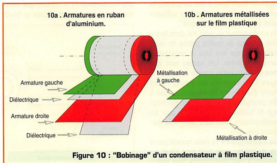
Figure 10 : "Bobinage" d'un condensateur à film plastique.
