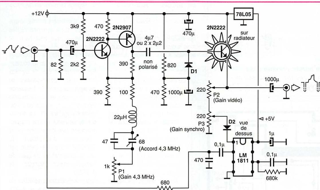
Figure 3 : Schéma complet de l'améliorateur de tops synchro.
