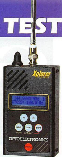
Capteur d'émissions FM proches. **XPLORER**
