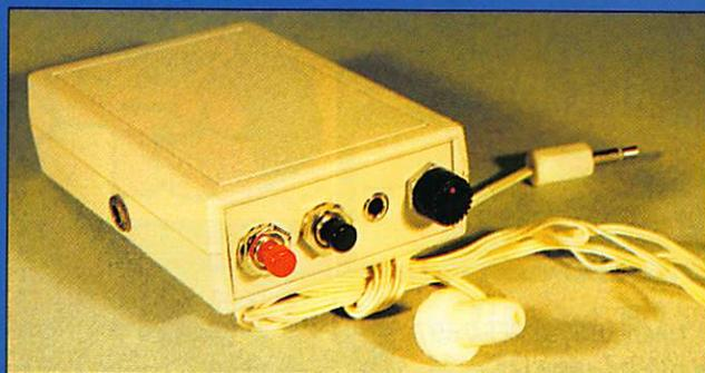
*Pour apprendre le Morse ou parfaire son entraînement jusqu'à 30 mots / minute. Alimenté par une pile 9 V (non fournie), livré avec un écouteur, ce prof électronique tient dans la poche de la chemise. Sert également d'oscillateur d'entraînement à la manipulation. Livré avec notice en français Présenté dans MEGAHERTZ n°182*
