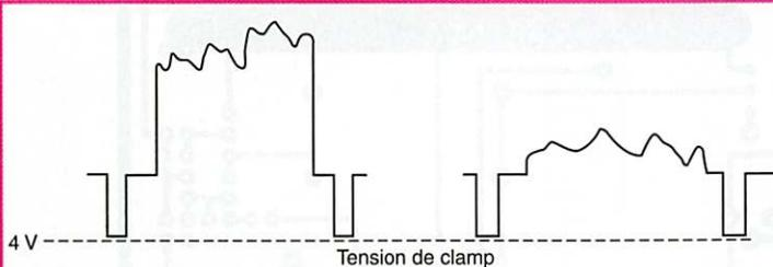
Figure 5 : Signal vidéo clampé à 4 volts.
