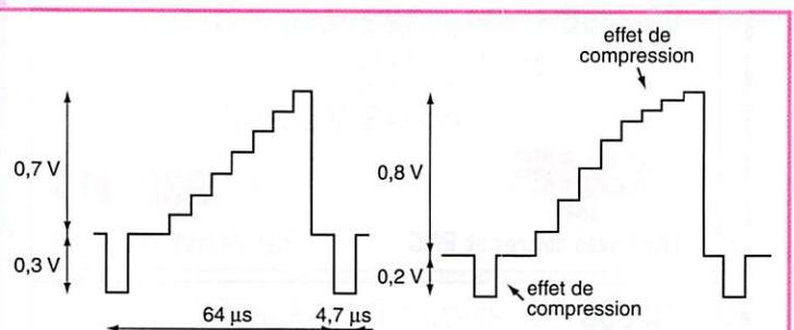
Figure 1 : A gauche un signal vidéo standard, à droite ce même signal après distorsions successives.
