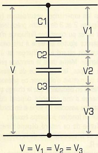
Figure 7 : Condensateurs montés en diviseur de tension.
