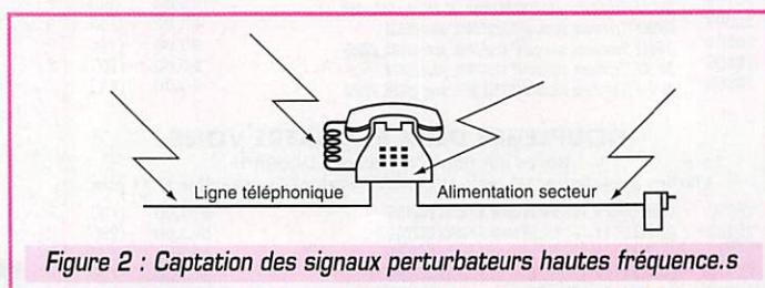
Figure 2 : Captation des signaux perturbateurs hautes fréquences.
