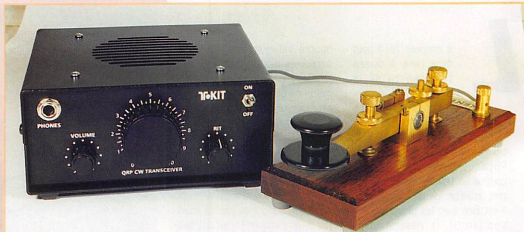
l'espacement des spires de la self du VFO mais elle atteint sans problème les 60 à 70 kHz couvrant largement le segment utilisé habituellement en CW sur 40 m. Le transceiver est doté d'un RIT (décalage de la fréquence de réception) et d'un circuit sidetone. La place laissée libre dans le boîtier laisse envisager la possibilité d'y inclure un petit keyer (nouvelle génération des CMOS keyers, par exemple).
