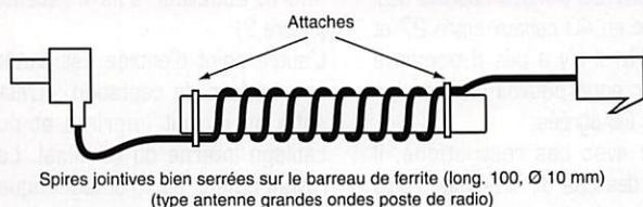
Figure 7 : Installation du barreau de ferrite.
