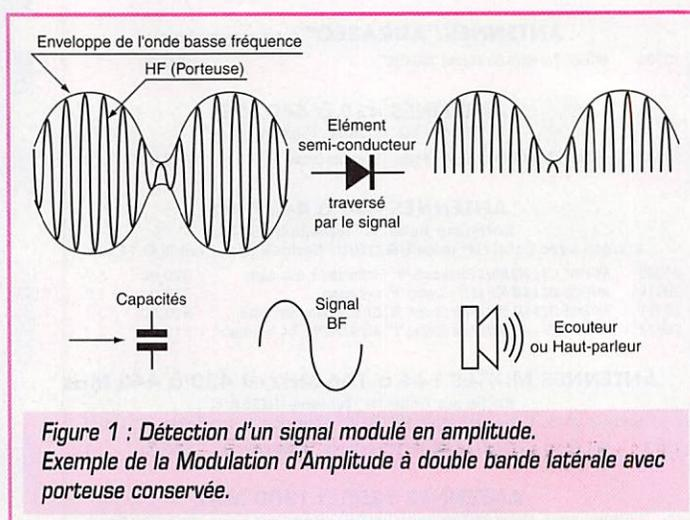
Figure 1 : Détection d'un signal modulé en amplitude. Exemple de la Modulation d'Amplitude à double bande latérale avec porteuse conservée.
