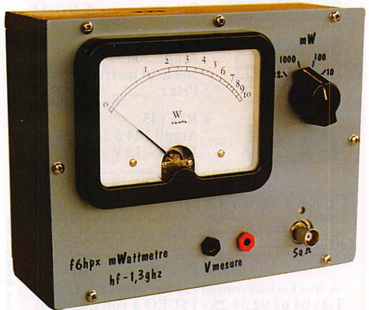
**L'appareil présenté permet les mesures de puissance, depuis 2 mW jusqu'à 1 watt, en trois gammes, 10, 100 et 1 000 mW. La mesure des puissances supérieures est naturellement possible avec l'utilisation d'atténuateurs extérieurs.**
