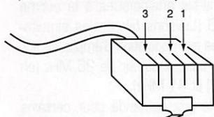
Figure 6 : Repérage des fils côté fiche RJ Téléphone.
