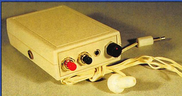
Pour apprendre le Morse ou parfaire son entraînement jusqu'à 30 mots / minute. Alimenté par une pile 9 V (non fournie), livré avec un écouteur, ce prof électronique tient dans la poche de la chemise. Sert également d'oscillateur d'entraînement à la manipulation.
