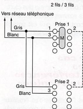
Dans le cas de terminaux récents (claviers à fréquences vocales) et sans sonnerie ancienne (électromécanique), deux fils suffisent.
