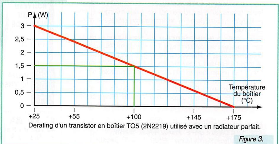
Derating d'un transistor en boîtier TO5 (2N2219) utilisé avec un radiateur parfait.
