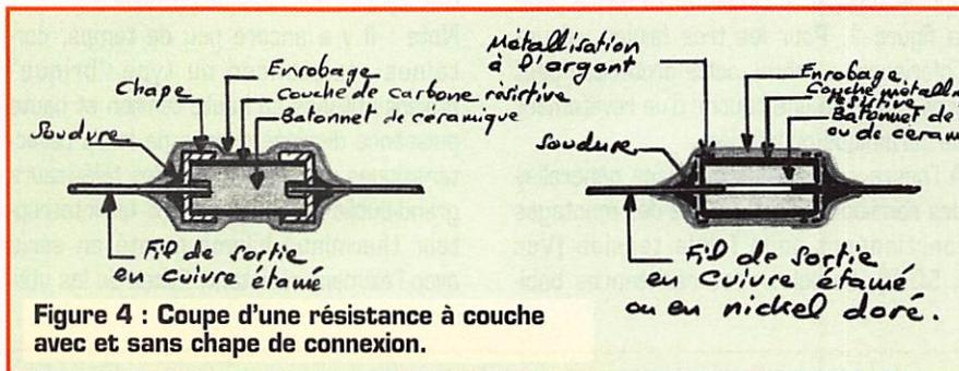
Figure 4 : Coupe d'une résistance à couche avec et sans chape de connexion.
