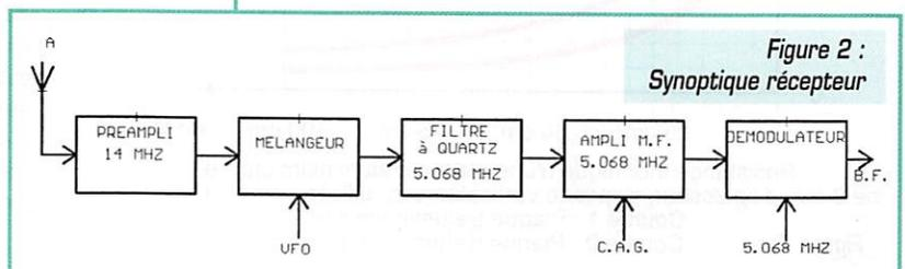
Figure 2 : Synoptique récepteur
