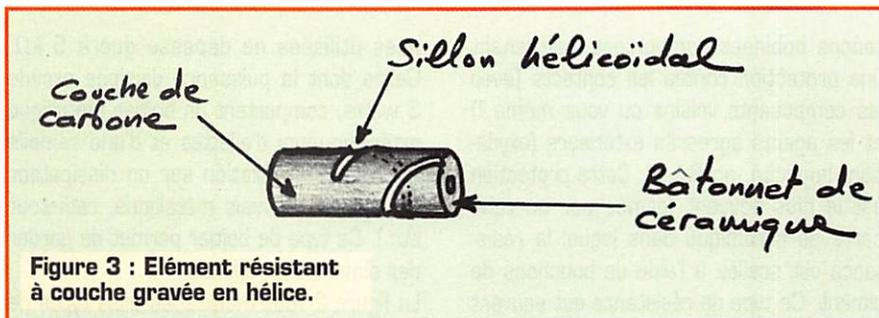
Figure 3 : Élément résistant à couche gravée en hélice.
