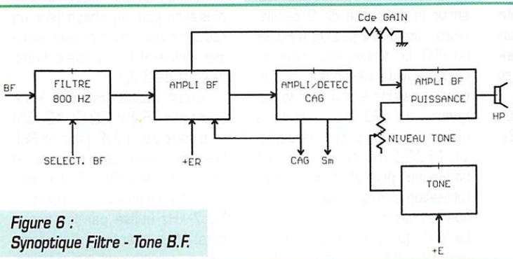
Figure 6 : Synoptique Filtre - Tone B.F.
