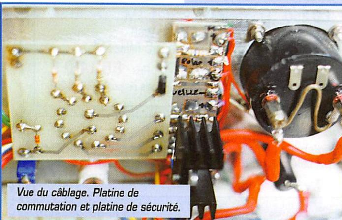
Vue du câblage. Platine de commutation et platine de sécurité.
