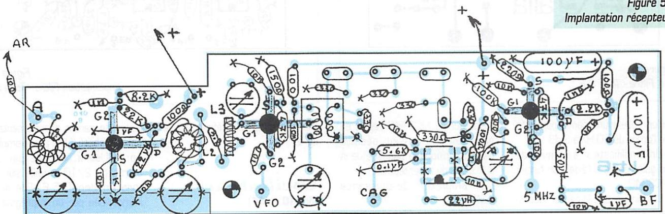
Figure 5 : Implantation récepteur.
