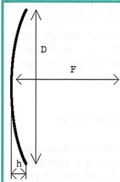
**Voici comment l'on mesure les dimensions d'une parabole :**
