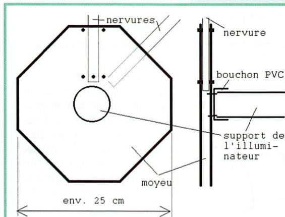
**Seuls les perçages pour une des nervures sont représentés. Il y a 8 nervures en tout. Les huit côtés du moyeu sont de dimensions égales. Une fois le moyeu assemblé, les tubes formant les nervures sont pris en sandwich entre les deux plaques. J'ai utilisé des vis M3 dans chacun des perçages. Ne pas oublier de percer la plaque avant pour pouvoir y fixer le bouchon en PVC qui va maintenir le support de l'illuminateur. Prévoir aussi des perçages pour pouvoir fixer la parabole à son support.**
