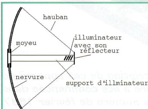
**Vue globale de l'antenne parabolique. Les haubans servent à la fois à donner sa forme concave au réflecteur et à maintenir l'illuminateur au point focal.**
