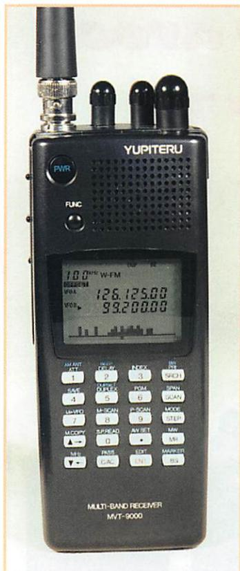
La sensibilité est bonne : au générateur, -120 dBm pour un signal FM audible ; -110 dBm donne un signal très confortable sur 145 MHz (je vous le promets, je serai un jour équipé des matériels nécessaires pour compléter mon labo et faire des mesures plus sérieuses que celles-ci, avec SINAD!).
