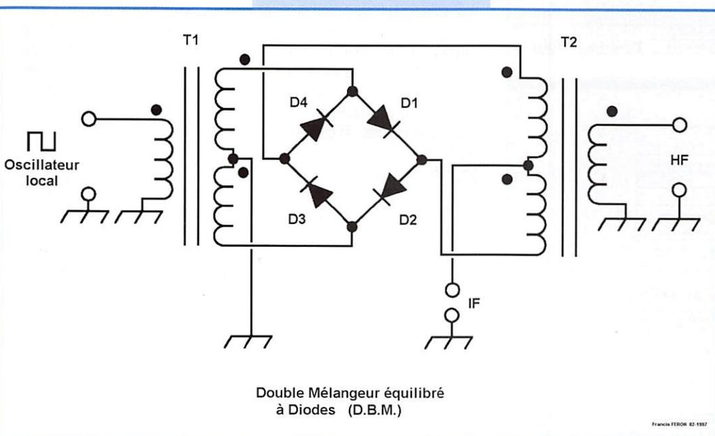
vue du type, et donc de la référence employée, mais aussi du point de vue de leur comportement. L'utilisation de circuits intégrés contenant au moins quatre diodes sur le même substrat est un bon choix. Utiliser des diodes classiques provenant du même lot de fabrication en est un autre, surtout avec les produits récents qui ont des tolérances serrées.
