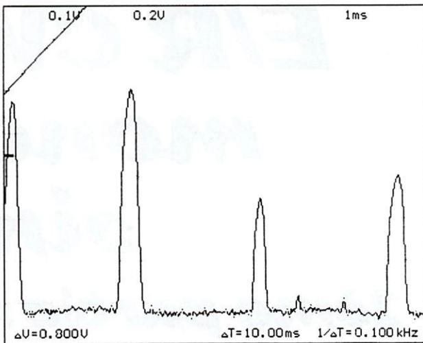
Porteuse 280 MHz - 30 dBm sans filtre IF 76 MHz.
