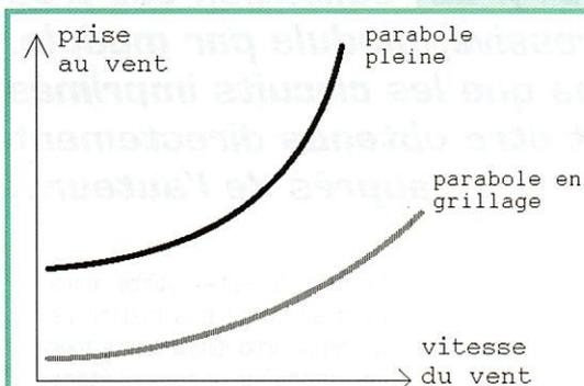
**Comparée à une parabole pleine de même diamètre, la prise au vent d'une parabole en grillage est plus faible et n'augmente pas aussi fortement en fonction de la vitesse au vent.**
