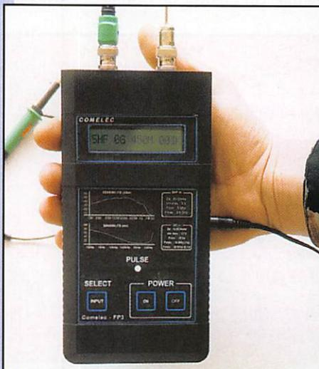
COMELEC est un fréquencemètre, proposé en kit ou tout monté, couvrant de 10 Hz à 2,8 GHz. Comme le montre la photo, il a le format d'un contrôleur universel. L'accent a été porté sur la précision, la fiabilité et la sensibilité. L'appareil est bâti autour d'un 68HC11.
