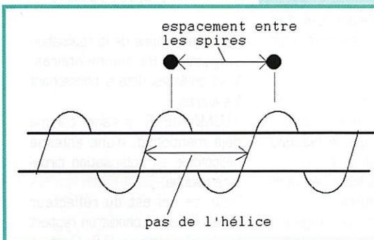
**Voici de quoi doit avoir l'air une antenne hélicoïdale en polarisation circulaire gauche. Le mandrin n'est pas nécessaire pour la réalisation décrite ici. Il sert seulement à montrer dans quel sens les spires sont enroulées. Ne pas confondre pas de l'hélice et distance entre les spires...**
