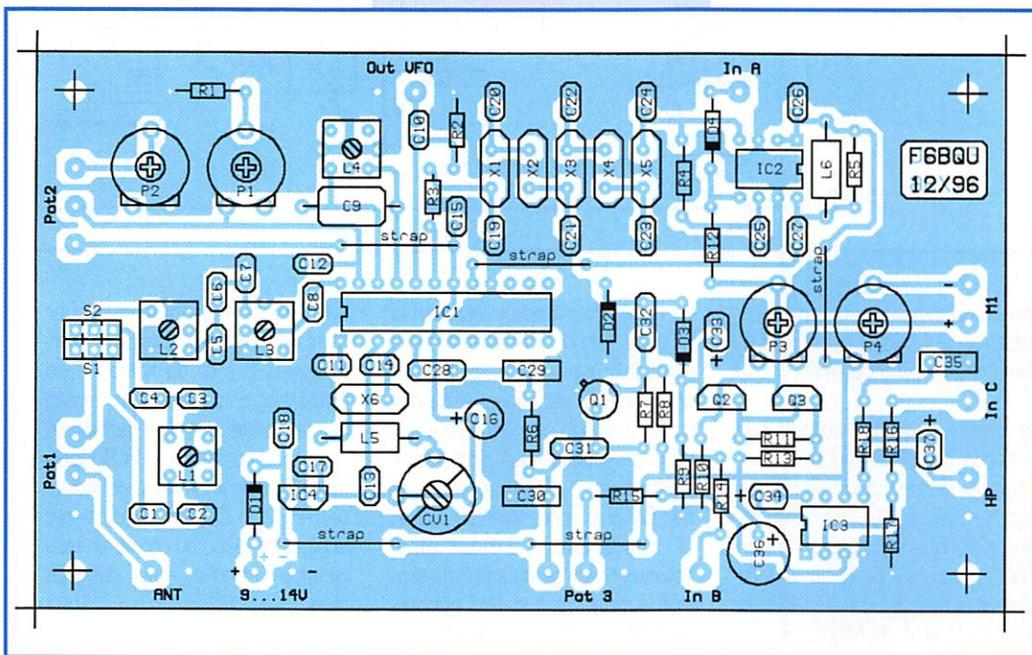
deur de pièces détachées ou à un de vos amis bricoleur. Monter les éléments les plus petits avant les plus grands. Vérifier la qualité de chaque soudure et la présence d'éventuels ponts de soudure. La quasi totalité des pannes est due au non respect des règles précédentes.
