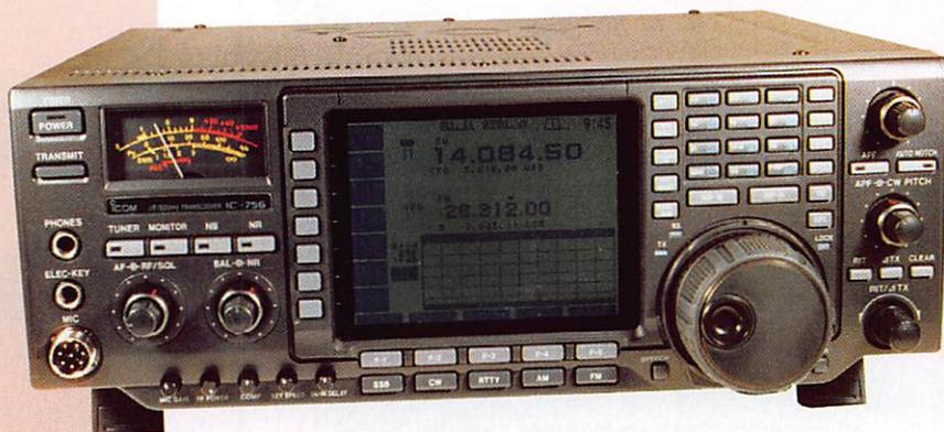
**Le tout nouveau transceiver décimétrique d'ICOM, l'IC-756, hérite de son aîné, l'IC-781, d'un concept qu'aucun autre constructeur de matériels pour radioamateurs n'a osé mettre en pratique: une large visu faisant office d'analyseur de spectre. De plus, le nouveau-né couvre le 50 MHz...**
