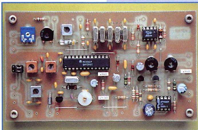
MC3362 étant de 200 ohms, le signal est prélevé sur la prise milieu de L3.
