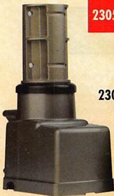
**23050** Rotor 50 kg - AR300XL Alim. 220 V - Moteur 18 V Rotation 360° + 5° Charge max.: 45 kg Livré avec pupitre
