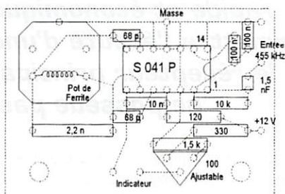
**Fig. 2.** — Circuit imprimé et plan d'implantation de l'indicateur d'accord de la figure 1. Un faible rayonnement sur la fréquence intermédiaire et ses harmoniques étant possible, un blindage peut être avantageux.
