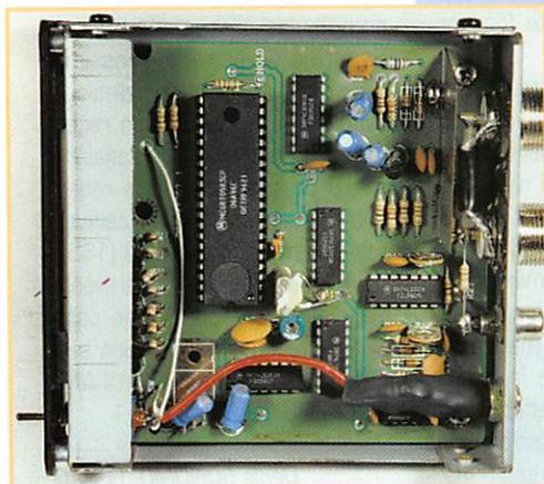
Le fréquence-mètre n'est pas encombrant: son boîtier de couleur noire ne mesure que 110 x 110 x 35 mm. Les entrée et sortie antenne se font sur des connecteurs SO239.
