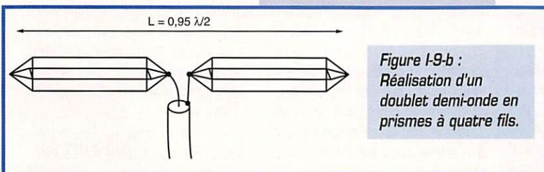
Figure I-9-b : Réalisation d'un doublet demi-onde en prismes à quatre fils.
