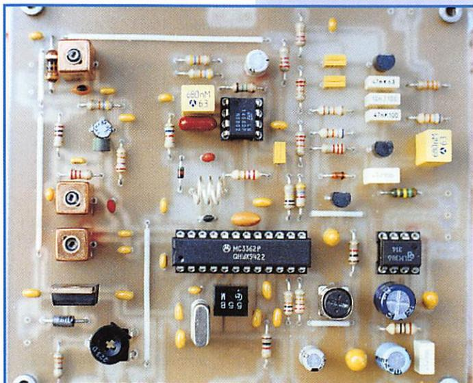
optimisée pour ce type de réception. Q2 et ses composants périphériques forment une cellule passe-bas et Q3 et ses composants périphériques une cellule passe-haut. A la sortie du filtre le signal emprunte deux chemins différents, l'un vers la sortie BF qui sera reliée à un convertisseur fax et l'autre vers l'ampli BF (LM386) qui sert à l'écoute locale dont le niveau est réglé par Pot3.
