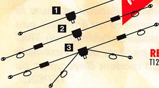
**1 DX-27** : Dipôle filaire omnidirectionnel E/R, résonance 1/2 onde, puissance 500 W, balun étanche sur ferrite fermée, câble en acier inoxydable toronné, longueur 5,5 m, avec spires de réglage 27 à 32 MHz, isolateurs (5000 V) porcelaine, gain + 3,15 dBi, livrée prérégulée.
