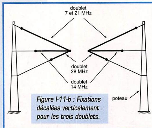
Figure I-11-b : Fixations décalées verticalement pour les trois doublets.
