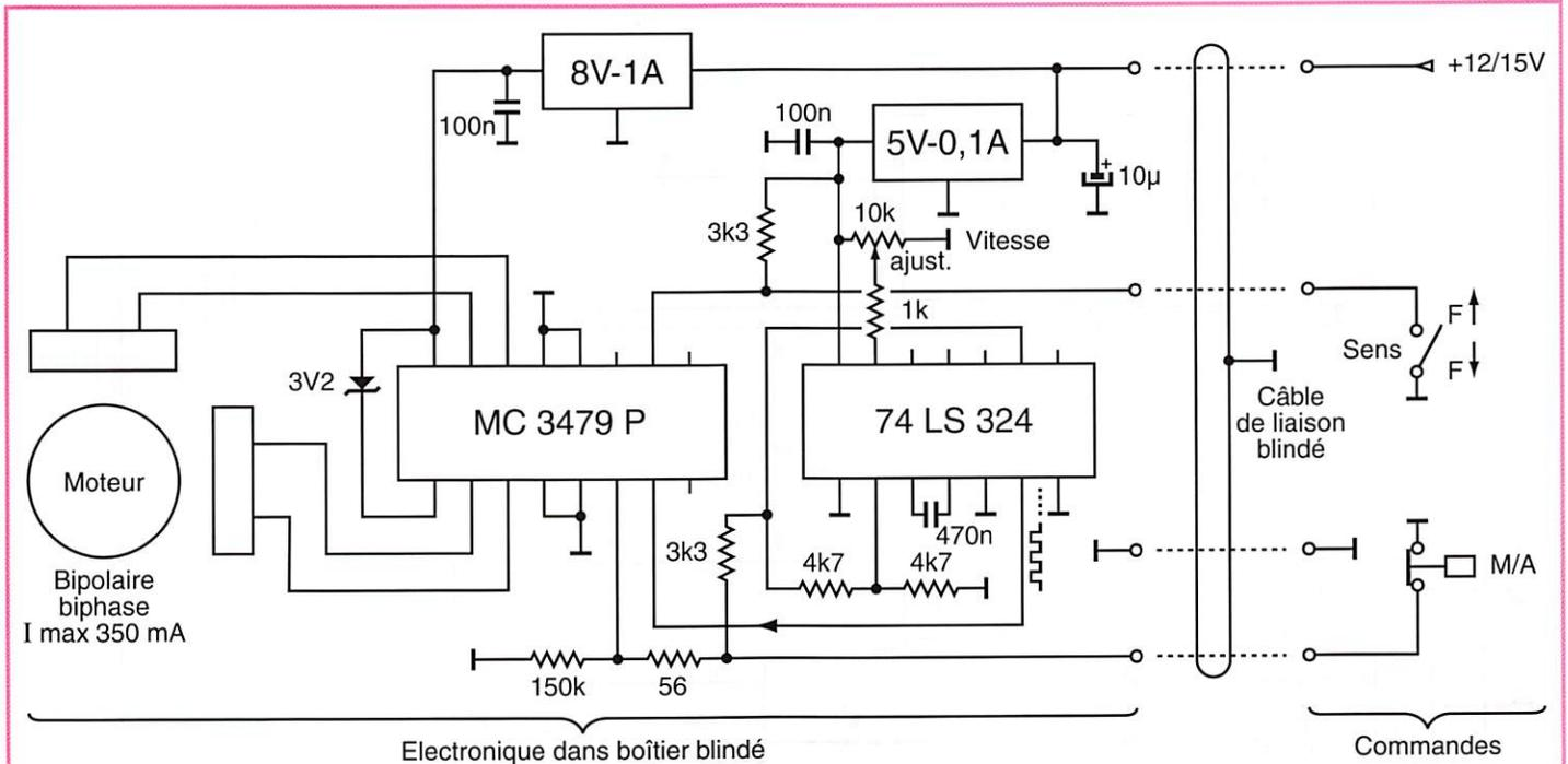
Dans cette configuration, à l'arrêt, il ne subsiste pas de couple de maintien sur le moteur.
