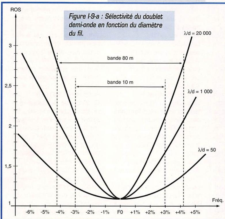
Figure I-9-a : Sélectivité du doublet demi-onde en fonction du diamètre du fil.
