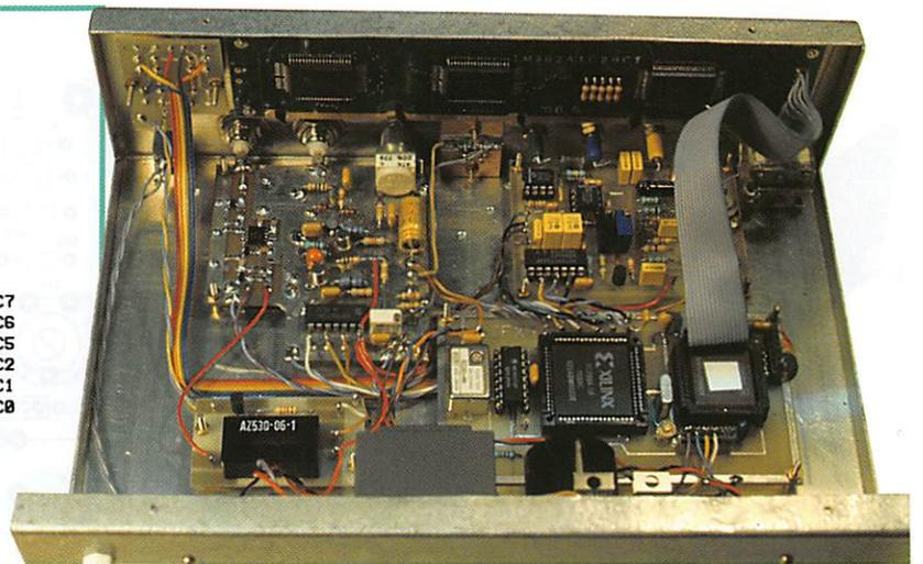
faut maintenant installer l'ensemble dans le boîtier. Toutes les entretoises d'écartement sont identiques et déterminées pour amener P1 juste à la bonne hauteur. Utiliser de la visserie de 2 mm, c'est largement suffisant. Notons que des blindages en alu léger (5/10) sont à prévoir pour les entrées Fx et CAP. Les mettre au dernier moment.
