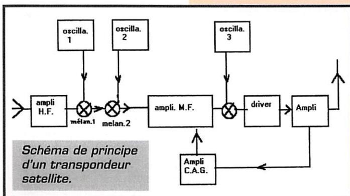
**Schéma de principe d'un transpondeur satellite.**
