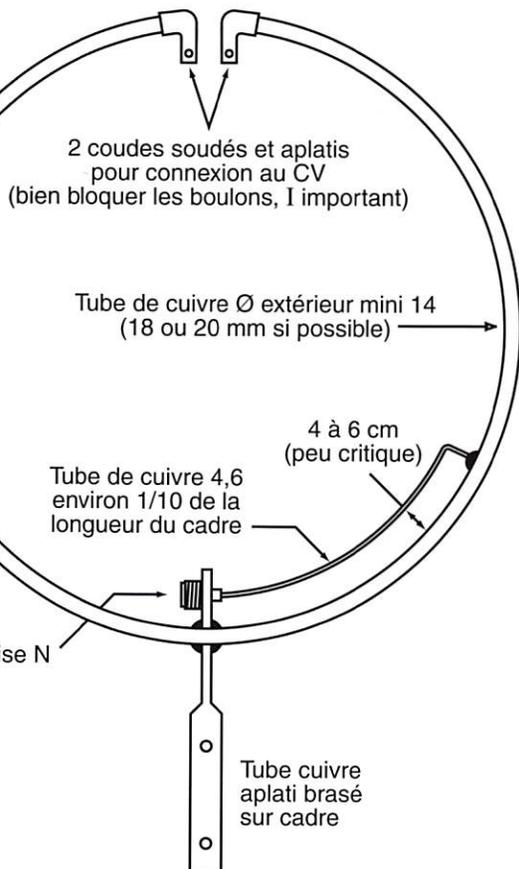
Régler, sur une bande médiane, la longueur du gamma pour TOS mini (court-circuit provisoire, puis soudure), une alimentation par boucle de couplage, diamètre 1/5 du cadre est également possible.
