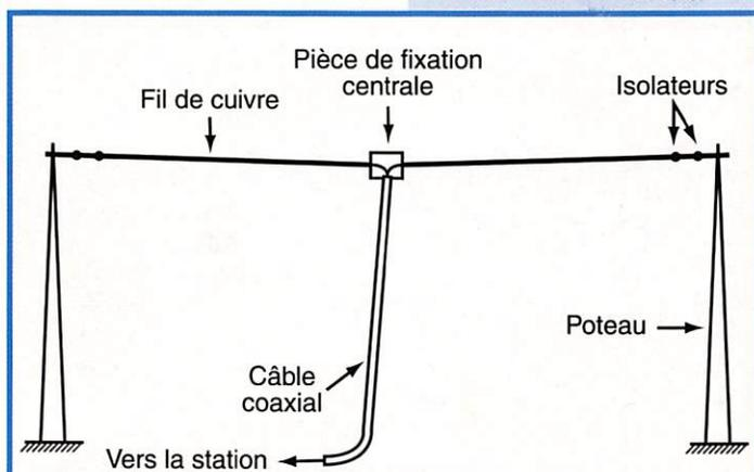
Figure I-7-2-a : Doublet demi-onde suspendu entre deux supports.
