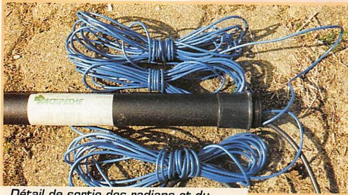
Détail de sortie des radiants et du coaxial.
