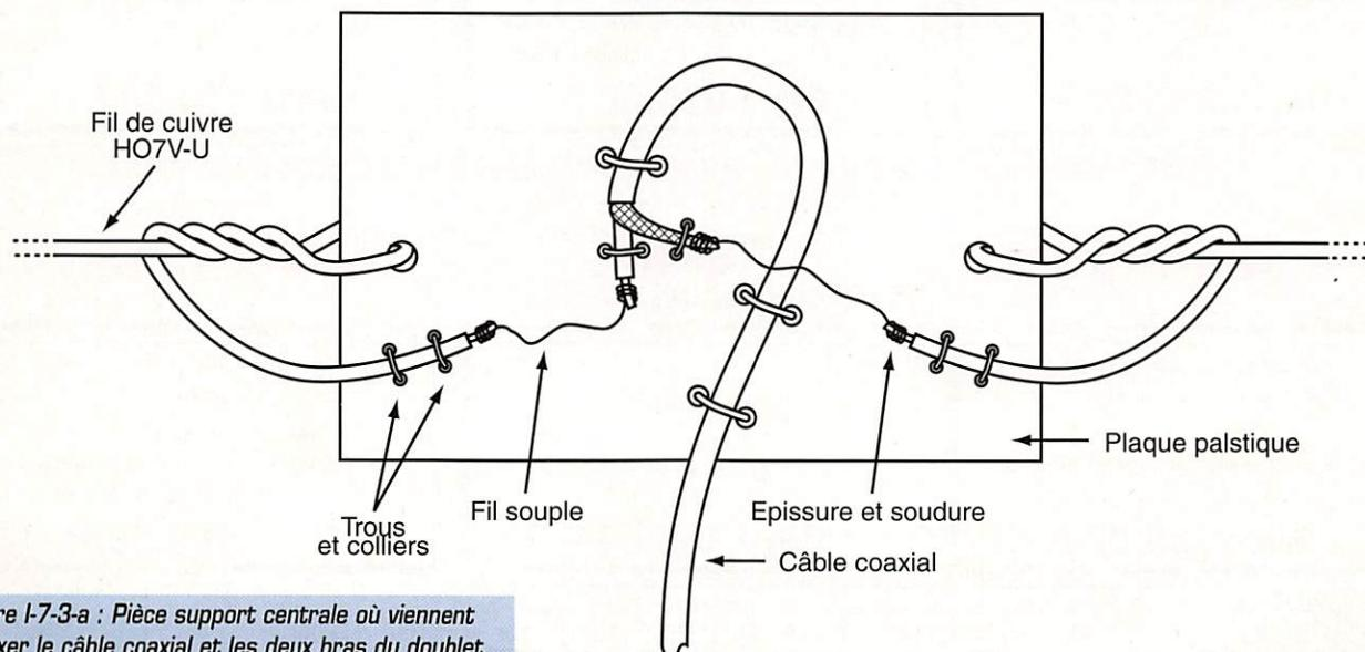
Figure I-7-3-a : Pièce support centrale où viennent se fixer le câble coaxial et les deux bras du doublet.
