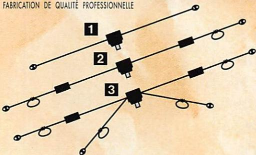
**1** DX-27 : Dipôle filaire omnidirectionnel E/R, résonance 1/2 onde, puissance 500 W, balun étanche sur ferrite fermée, câble en acier inoxydable toronné, longueur 5,5 m, avec spires de réglage 27 à 32 MHz, isolateurs (5000 V) porcelaine, gain + 3,15 dBi, livrée prérégulée.
