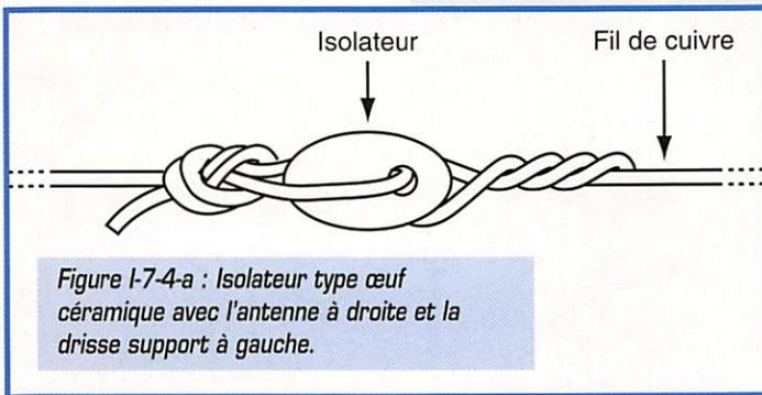
Figure I-7-4-a : Isolateur type œuf céramique avec l'antenne à droite et la drisse support à gauche.
