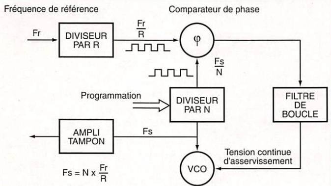
Dans ce schéma simplifié, le comparateur de phase donne une tension nulle à sa sortie à condition que les phases, donc les fréquences, soient égales. En cas de différence, la tension continue sera positive ou négative selon que  $F_r/R$  est plus grande ou plus petite que  $F_s/N$ . En pratique, lorsque la tension d'asservissement de boucle augmente, la fréquence du VCO baisse (principe d'une varicap dans un circuit LC).
