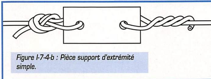
Figure I-7-4-b : Pièce support d'extrémité simple.
