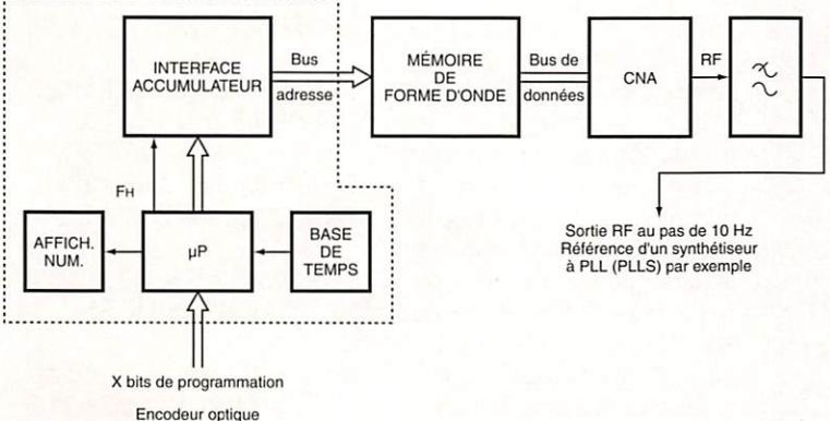
Figure 6 : Détail de la partie traitement.
