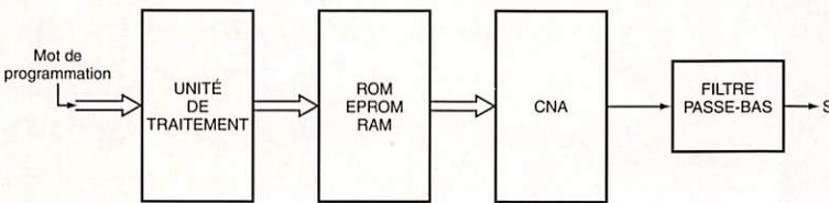
Figure 5 : Synoptique d'un système DDS simple.
