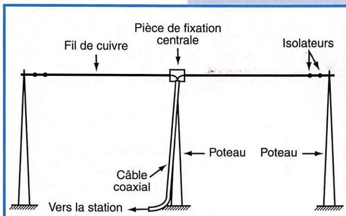
Figure I-7-2-b : Doublet demi-onde monté sur trois supports.
