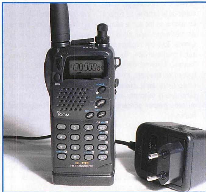
**Dernier né des portatifs de la gamme ICOM, l'IC-T7E est un transceiver FM fonctionnant sur les deux bandes, 144 et 430 MHz.**
