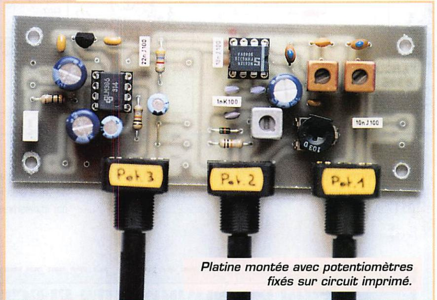
Platine montée avec potentiomètres fixés sur circuit imprimé.
