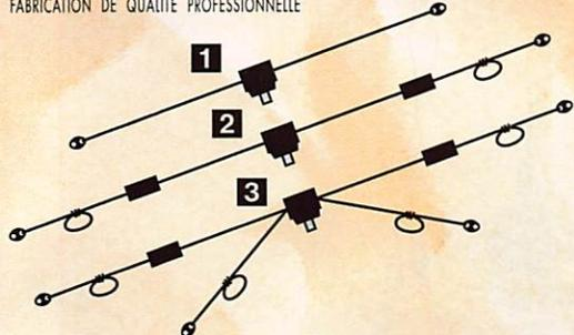
**1** DX-27 : Dipôle filaire omnidirectionnel E/R, résonance 1/2 onde, puissance 500 W, balun étanche sur ferrite fermée, câble en acier inoxydable toronné, longueur 5,5 m, avec spires de réglage 27 à 32 MHz, isolateurs (5000 V) porcelaine, gain + 3,15 dBi, livrée préréglée.
