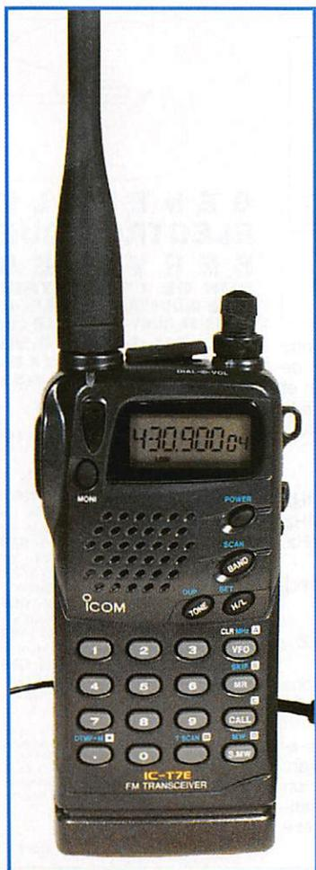
trous ménagés sur la face avant. Le LCD est d'une dimension acceptable, avec une taille de caractères qui ne fatiguera pas trop les yeux de l'opérateur. La commande PTT est sur le côté gauche de l'appareil. Précisons que l'on peut verrouiller les touches par la commande "LOCK". L'IC-T7E est livré avec une batterie CdNi de 7,2 V et son chargeur. Après quelques heures de mise en charge, vous pourrez donc faire plus ample connaissance avec l'appareil.
