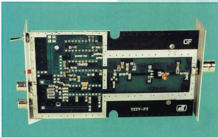
CMS. Le coeur de l'émetteur est un Plessey SP5066 et un microcontrôleur Thomson ST62E10. Les entrées vidéo et son se font sur des prises CINCH. L'antenne se branche sur une BNC. La LED placée en face avant indique le bon verrouillage du PLL. Son prix, voisin de 650 F, le rend accessible pour bien des applications (pourquoi pas sous un ballon, avec une caméra CCD miniature ?)... Disponible chez nos annonceurs
