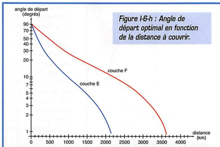
**Figure I-6-h :** Angle de départ optimal en fonction de la distance à couvrir.
