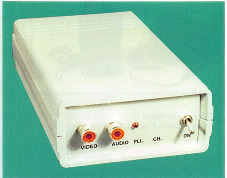
***Ce petit émetteur, proposé prêt à l'utilisation par Nuova Elettronica, est destiné à résoudre tous les problèmes de liaison vidéo UHF. Il existe en deux versions : fréquences programmables en bande TV ou fixe, sur 438.5 MHz (bande amateur).***
