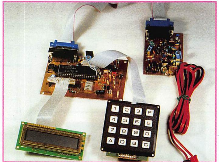
**Le synthétiseur de fréquences est à la base de toute réalisation d'émetteur-récepteur. La description suivante est à la fois originale et à mettre au point.**
