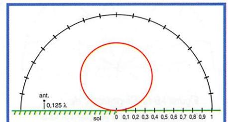
Figure 1-6-b : Diagramme de rayonnement dans le plan vertical d'un doublet demi-onde, fil horizontal placé à 0,125  $\lambda$  du sol.
