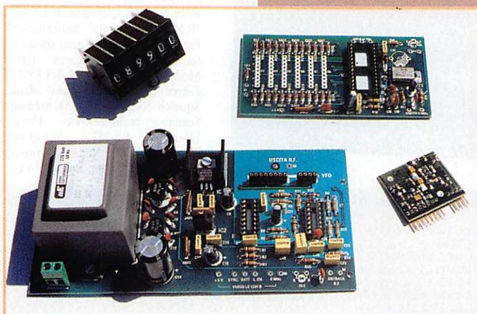
bier !). L'opération est délicate puisqu'il faut s'efforcer bien positionner les supports. On terminera en insérant les supports "femelles" dans les mâles (d'habitude ça ne se passe pas ainsi) et on termine en soudant les femelles dans leurs emplacements. En procédant ainsi, le bloc de roues codeuses tombe parfaitement à sa place. C'est la seule "difficulté" du kit.
