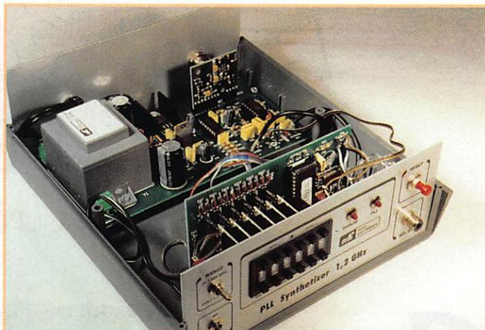
la prise "INP. BF" placée en face avant. L'excursion de fréquence est directement liée à l'amplitude du signal modulateur.
