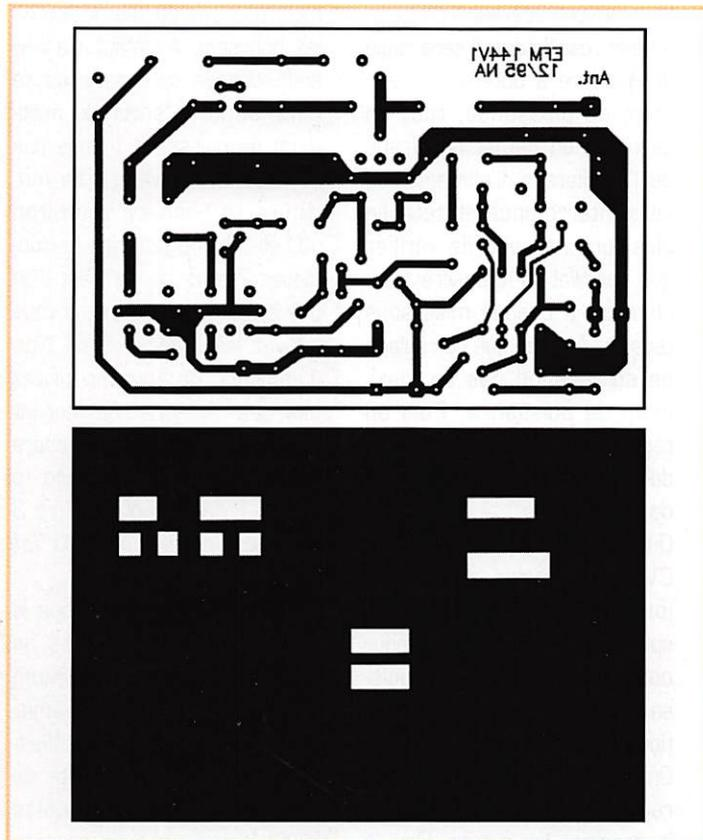
seront placées en premier, puis les condensateurs et les pots. Enfin, on terminera par les composants plus fragiles : transistors et circuit intégré. On veillera à effectuer une soudure sur les deux faces du circuit chaque fois qu'un composant est connecté à la masse. Les transistors BFY 90 sont montés à ras du circuit. Le boîtier de T3 sera soudé au circuit
