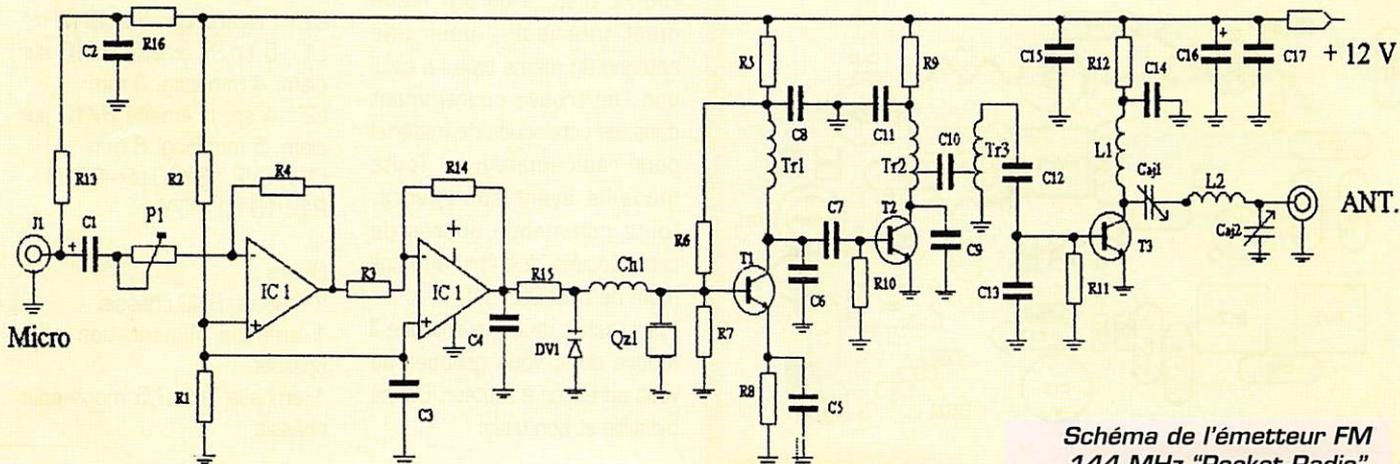
Schéma de l'émetteur FM 144 MHz "Pocket Radio".
