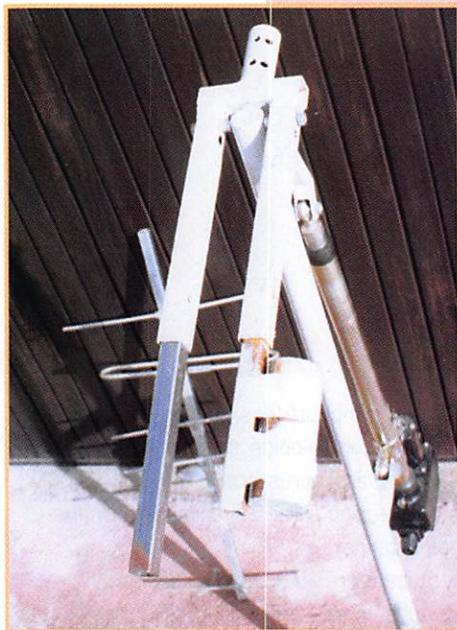
la verticale sans excès. La raison est que par un fort vent l'ensemble ne balance pas. Un quart en plus est raisonnable. Pour le contre-poids, du plomb coulé dans un bout de tube est une bonne solution.
