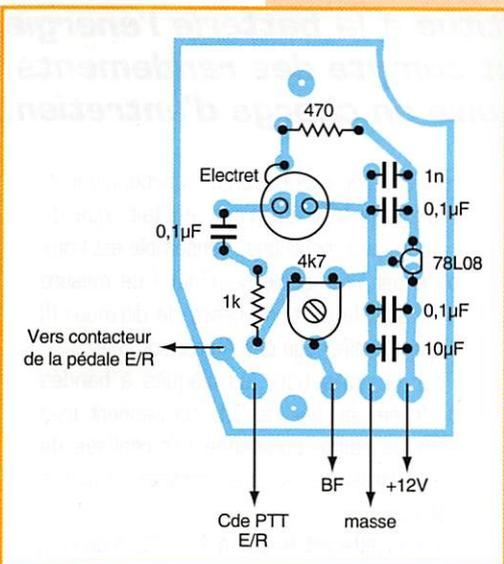
S'il n'est pas possible d'amener le 12 V du transceiver dans le micro, une alimentation par une pile de 1,5 V ou 3 V, directement intégrée, peut être envisagée. Il faut alors prévoir un inter M/A.
