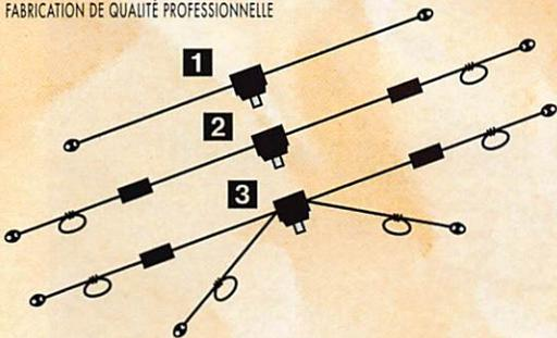
**1** DX-27 : Dipôle omnidirectionnel E/R, résonance 1/2 onde, puissance 500 W, balun étanche sur ferrite fermée, câble en acier inoxydable toronné, longueur 5,5 m, avec spires de réglage (27 MHz/32 MHz) isolateurs (5000 V) porcelaine, gain + 3,15 dBi - livrée préréglée.
