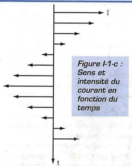
Figure I-1-c : Sens et intensité du courant en fonction du temps
