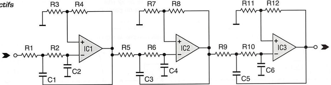
Figure 2 Filtrage analogique classique
