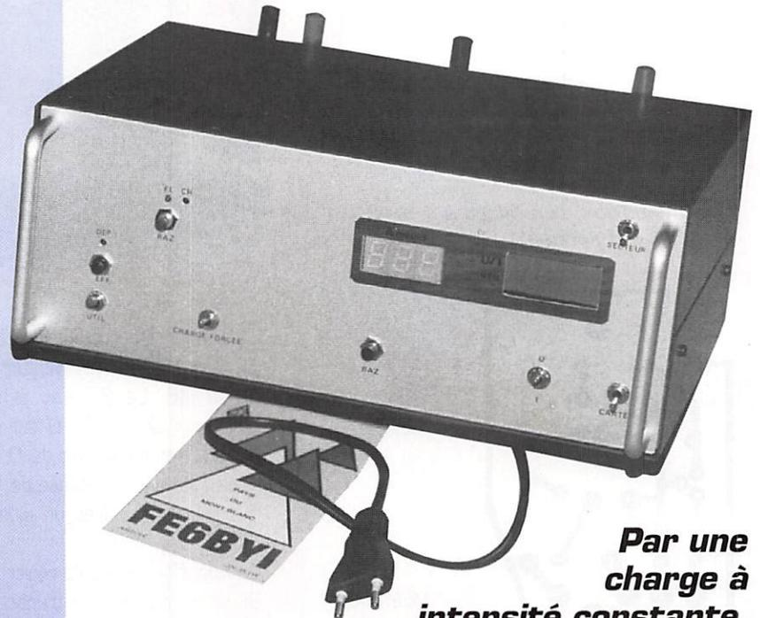
**Par une charge à intensité constante, favorable à la longévité de l'accumulateur, ce chargeur restitue à la batterie l'énergie consommée, en tenant compte des rendements, puis passe ensuite en charge d'entretien.**
