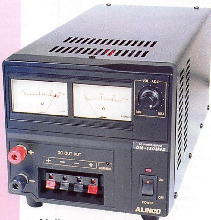
**L'alimentation d'une station et de ses périphériques doit tenir compte de critères de fiabilité. Le modèle DM 130 MVZ d'Alinco est prévu pour délivrer 25 A (rapport cyclique 50%) sous 13,8 V avec une sécurité convenable.**
