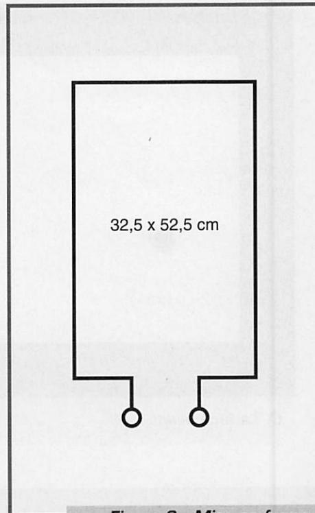
Figure 2. Mise en forme de la boucle
