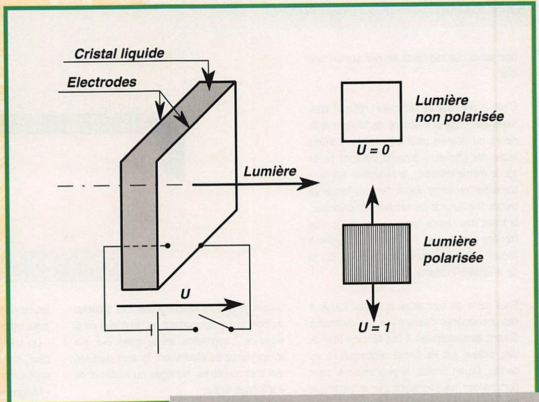
Figure 2. Principe du filtre polarisant à cristal liquide.
