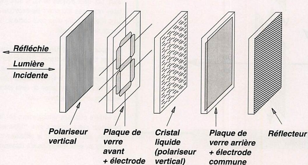
Figure 3. Constitution d'un afficheur LCD.
