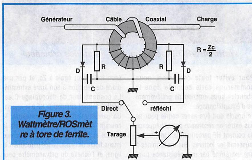
Figure 3. Wattmètre/ROSmètre à tore de ferrite.
