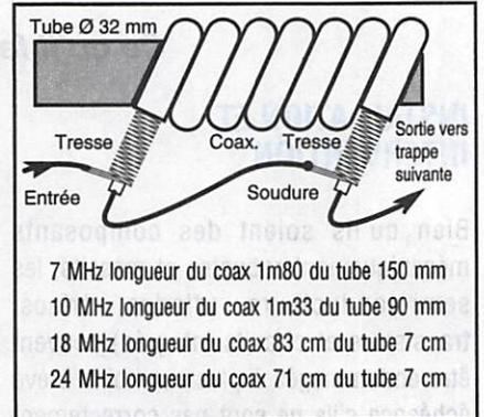
On peut aussi réaliser des dipôles à partir de câble coaxial, le câble sera du RG58
