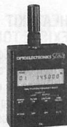
**M-1** – Fréquencemètre 10 Hz à 2,8 GHz. 2 gammes 10 Hz à 200 MHz et 200 MHz à 2,8 GHz. Affichage 10 digits LCD + bargraph 16 segments. Sortie RS-232 avec interface CX-12. Alimentation Cad-Ni 9 Vdc. Dimensions : 124 x 71 x 35 mm.
