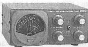
**CNW-727** – Coupleur 140-150 MHz, 200 W CW + 430-440 MHz, 150 W CW. Galvanomètre à aiguilles croisées, 20/200 W, éclairage cadran.
