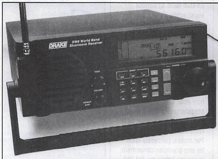
scopique. Tout de suite, une remarque au niveau des antennes : j'aurais préféré voir un socle coaxial pour l'antenne VHF, là où les concepteurs de chez Drake ont prévu une entrée 300  $\Omega$ . Une prise CINCH est réservée à l'enregistrement de vos émissions préférées. Par contre, et c'est dommage, le récepteur ne télécommande
