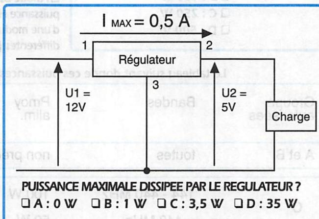
La dissipation Pmax du régulateur correspondra à Imax le traversant :
