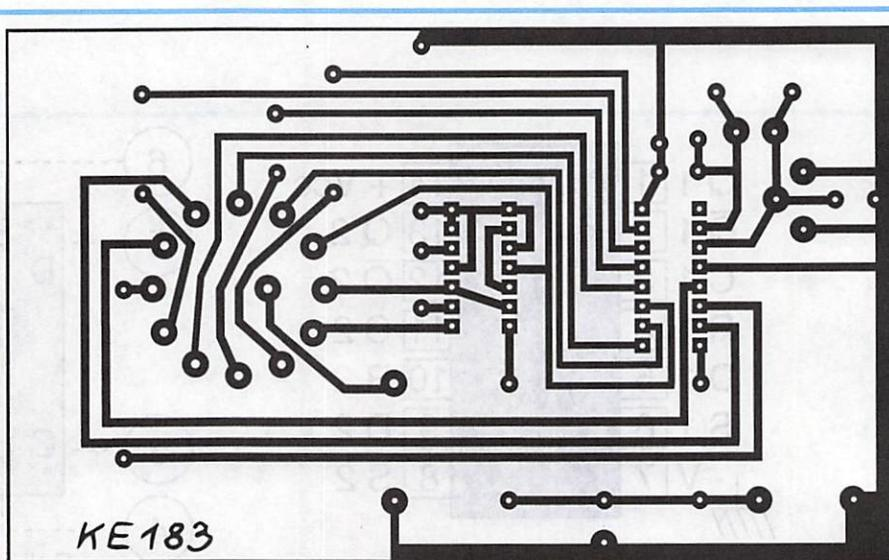
Figure 4 . Dessin du circuit imprimé à l'échelle 1 (mylar).
