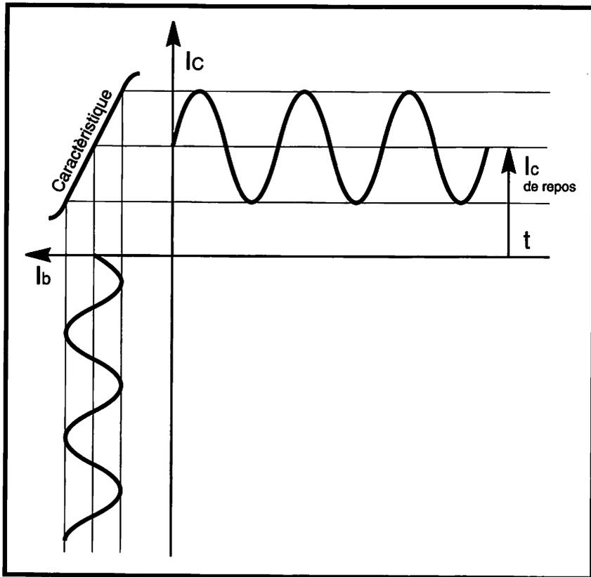
Fig. 3 - L'amplification en classe A.
