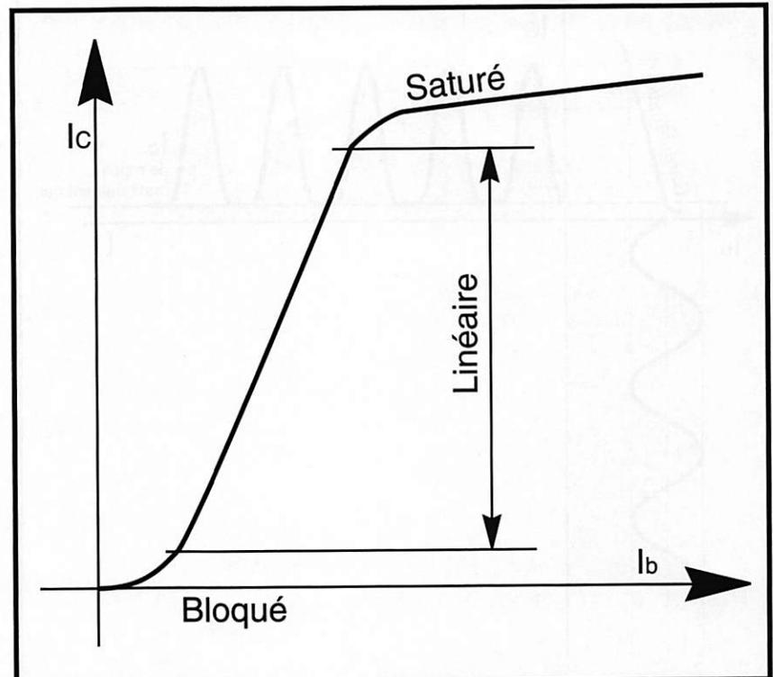
Fig. 2 - Caractéristique simplifiée\* de l'étage amplificateur.
