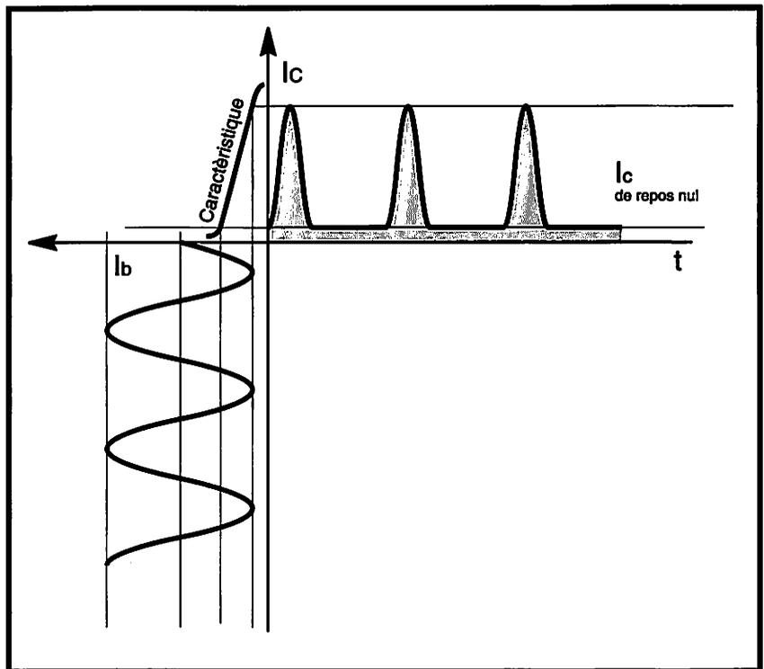
Fig. 4 - L'amplification du signal en classe C.
