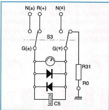
• En fonction « récepteur » il indique le niveau du signal RF reçu. (L'antenne et son réflecteur sont alors un peu directionnels)
