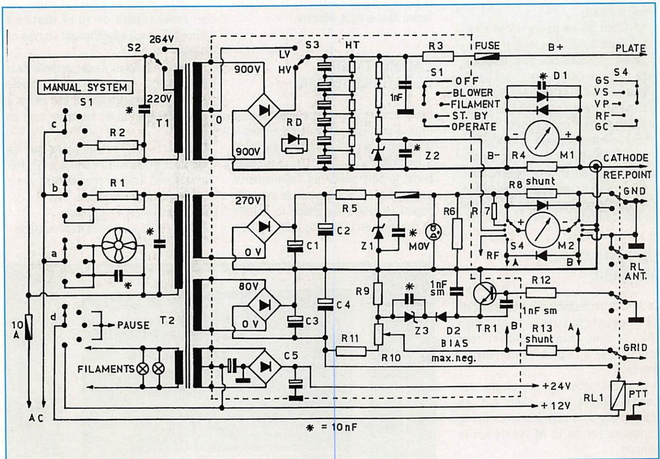
**Figure 2 - Schéma de l'alimentation de l'amplificateur linéaire "à grille-écran à la masse". Elle est visible sur les photos. Elle peut être utilisée telle quelle avec les tubes 4X150A (7034) et 4CX250B (7203) aussi bien en HF qu'en VHF. Les tubes 4X150G demandent des supports spéciaux et un secondaire de T2 différent pour leurs filaments (voir Tableau 1).**
