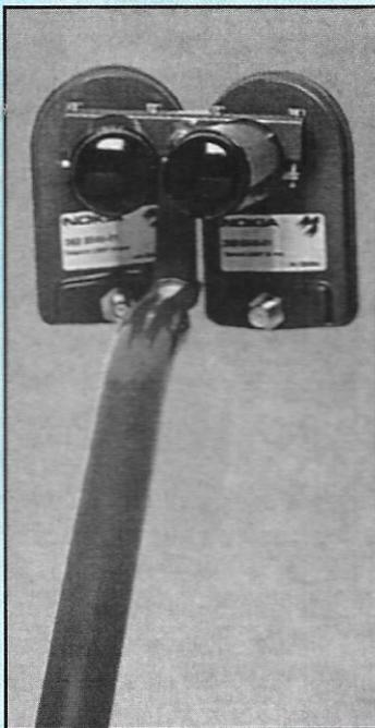
**Un exemple dans lequel les deux têtes sont placées de part et d'autre du foyer de la parabole: le kit Télécom duo de Nokia. Les deux câbles qui partent des deux têtes peuvent être soit couplés, pour ne faire plus qu'un, soit descendre jusqu'au démodulateur, s'il possède deux entrées satellite.**
