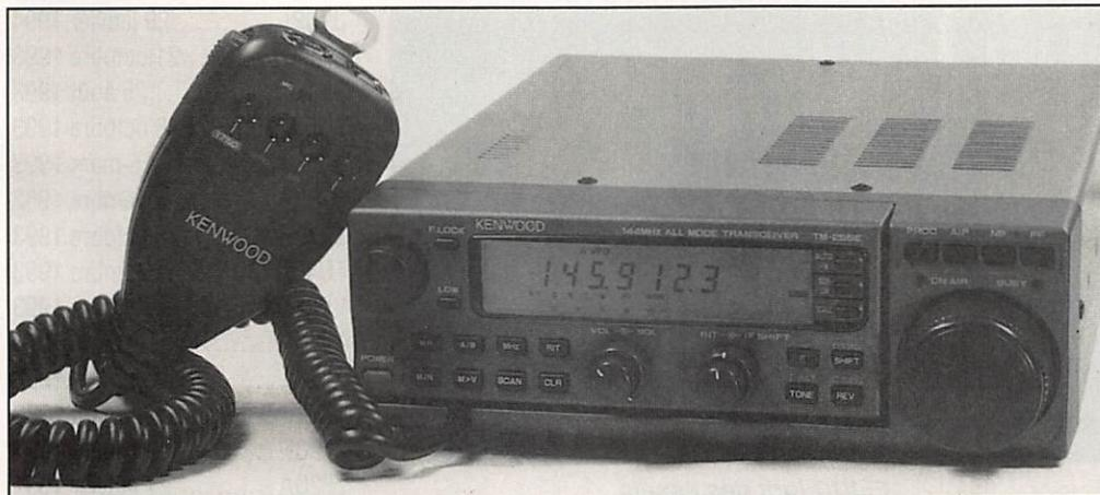
ficateur, pour peu que l'antenne soit à la hauteur (j'ai pas fait exprès !). Les adeptes du packet seront ravis de savoir que l'appareil est conçu pour le 9600 baud. L'alimentation sera extérieure, 13,8 V sous une quinzaine d'ampères. Il existe une version 70 cm de ce transceiver; c'est le TM-455E. Présentation de la petite bête, en
