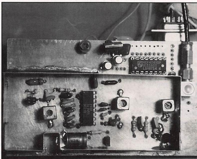
Démodulateur H.R.P.T. avec SL 1451.
