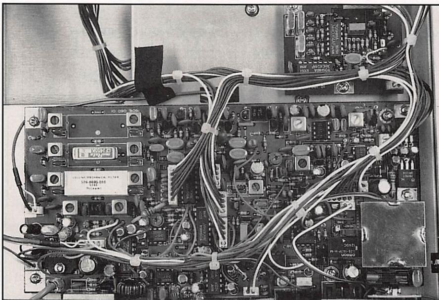
Un câblage propre. Notez les emplacements des filtres céramiques ou mécaniques.
