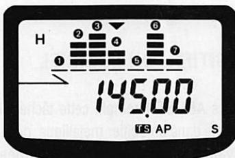
L'espacement est fonction du pas des canaux. Le tableau illustre un exemple avec pas de 25 kHz et fréquence centrale de 145,000 MHz.
