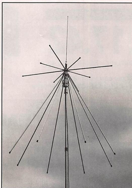
L'antenne est assemblée en une vingtaine de minutes, prête à fonctionner. Un dispositif spécial permet de la fixer sur un tube vertical. Ce support, fileté, vient se monter sous la pièce maîtresse d'où partent les éléments. Une contre-plaque assure le serrage sur le mât. Une petite feuille fait office de fiche descriptive plus que succincte.
