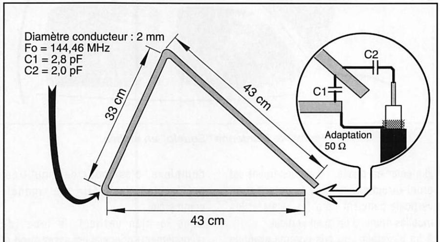
Figure 2-5. L'antenne TRIANGLE accordée sur 144,46 MHz
