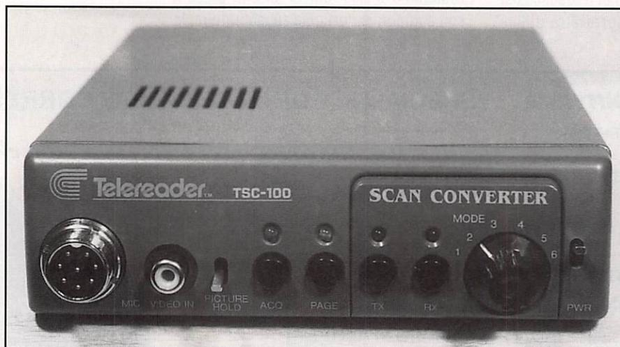
prises. Un connecteur micro à 8 broches, une CINCH pour l'entrée vidéo, des poussoirs de sélection et de commande, un commutateur pour changer de mode... A l'arrière, on trouve de nombreux connecteurs : alimentation 13,8 V, DB-9 pour une souris, sortie CINCH pour la vidéo, des jacks et une DIN pour les
