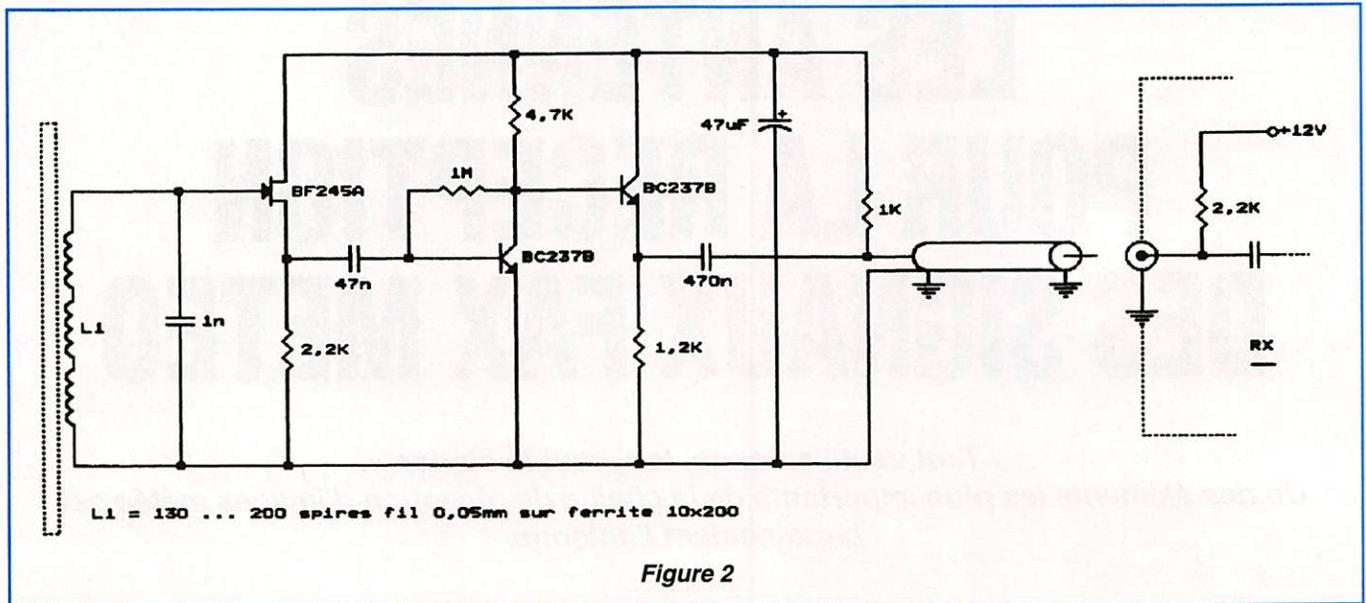
coaxial de liaison au récepteur. Si le récepteur n'a pas de prise antenne alimentée, il suffit de débrancher la résistance de 1 Kohms du câble et de la relier directement à une source 12 volts stabi-
