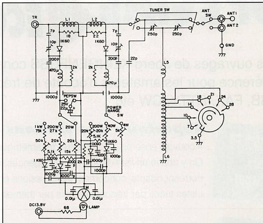
de ne pas détériorer la boîte de couplage... et l'étage final de l'émetteur. Les mesures de TOS peuvent être effectuées à partir de 5 W. Il n'est pas nécessaire de réaccorder à chaque changement de fréquence dans une même bande, tant que le TOS reste dans des limites acceptables (< 1/1.5).
