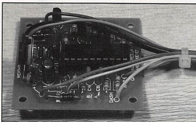
"KEY 1", certaines pattes du 8044 sont inutilisées, comme la mesure de vitesse ou le "monitoring". Cela permet de conserver un montage aussi simple que possible. Un transistor assure l'interface avec la ligne de manipulation positive de l'émetteur (limitation : 30 V et 50 mA).
