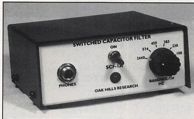
amplificateur audio composé d'un classique LM 386, capable d'exciter un casque (on excite ce qu'on peut !). L'alimentation est en 12 V externe, un régulateur interne l'abaissant à 9 V pour les deux circuits MF8C et leur horloge (NE555). A l'entrée comme à la sortie, on trouve une cellule de filtrage HF. Les valeurs de bande passante, très précises (108 Hz, 459 etc.) sont, en fait, des valeurs calculées à -3 dB.
