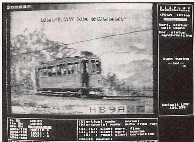
JVFX, à l'aide d'un circuit interface, peut recevoir et émettre en FAX et en SSTV. Les schémas des interfaces sont fournis avec le logiciel, sur la disquette, en ".GIF". Le plus simple est un circuit de mise en forme basé sur un "ampli-op". Les plus performants vous donneront des images d'une incroyable qualité. L'un de ces circuits est Easyfax, déjà décrit dans notre N°118.
