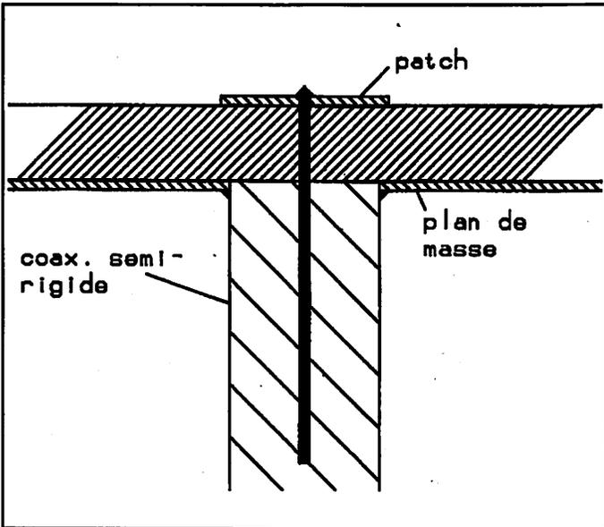
4 - Alimentation de l'antenne par un câble coaxial.
