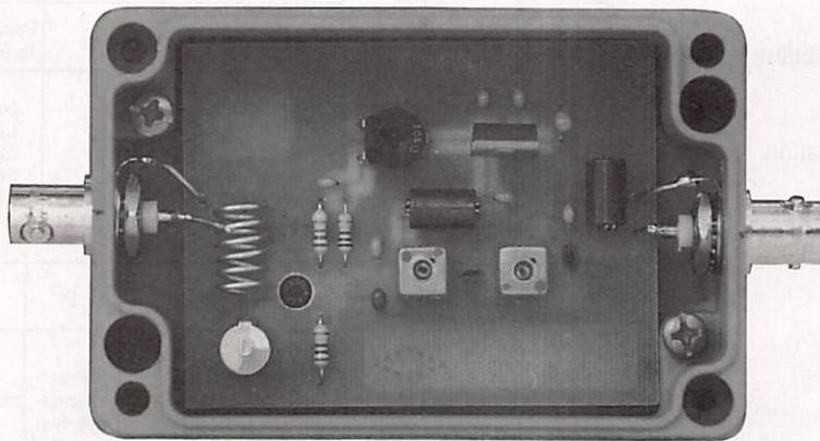
de qualité (self en fil argenté), ne dégradera pas trop le facteur de bruit. Une liaison directe entre la self et l'antenne évite l'électricité statique, si destructrice pour les transistors GasFet. Mais attention à ne pas inverser le branchement entre antenne et sortie,
