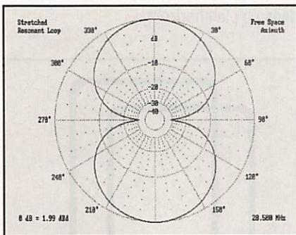
Dans le but de pousser encore plus loin l'étude du système, j'en ai alors réalisé une maquette au 1/10ème auto-portante et rotative pour la bande des deux mètres. Montée à un mètre au-dessus du sol, elle me permet ainsi de mesurer, avec une grande facilité, les rapports avant-arrière et avant-côtés. La hauteur correspondant à une demi-longueur d'onde sur deux mètres, je simulais ainsi un système qui, en grandeur réelle, était
