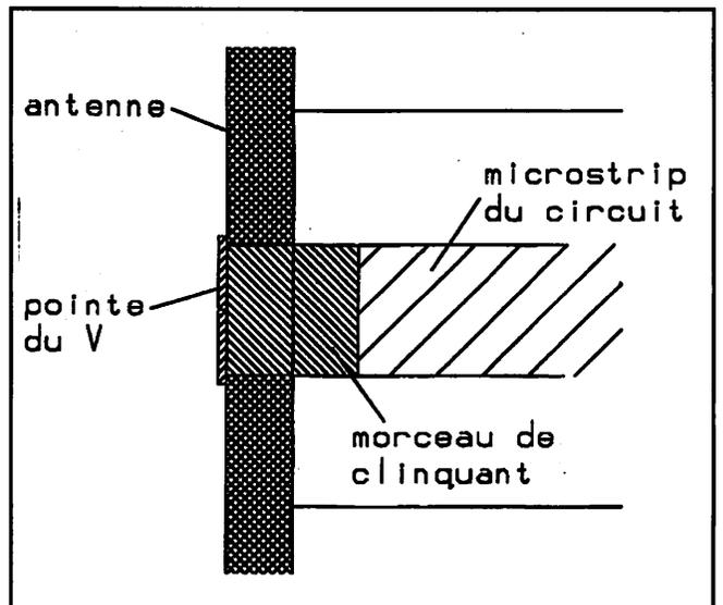
5 a) - Alimentation de l'antenne par une ligne microstrip
