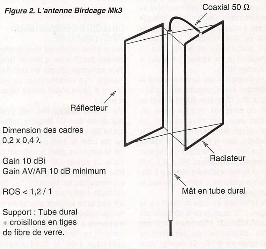
prévu pour la bande des 20 mètres et situé à 10 mètres au-dessus du sol.
