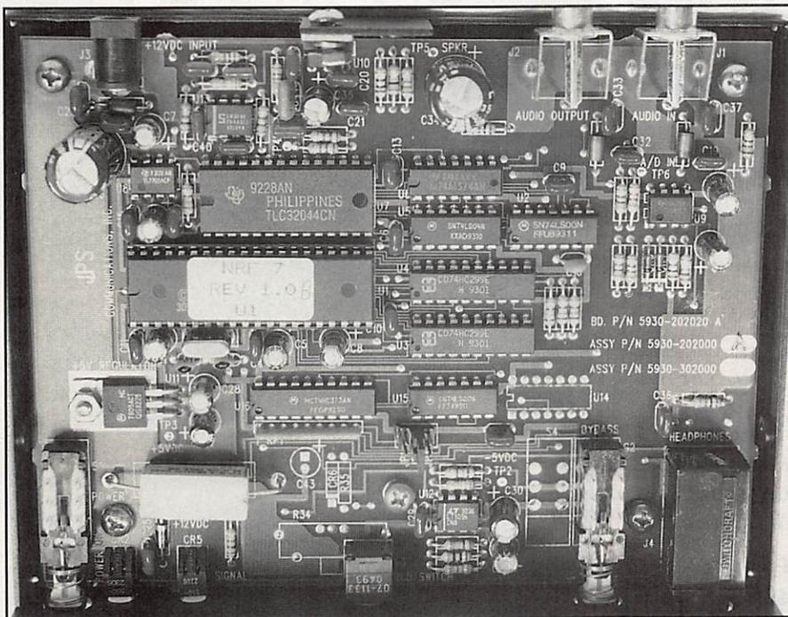
large de 500 Hz, il est centré sur 2200 Hz. Rappelons que, en Europe, les fréquences retenues pour le MARK et le SPACE en RTTY sont dites "basses" (1275 et 1445 Hz) alors que le couple employé par les américains est centré... sur 2200 Hz. Dommage ! Il reste à souhaiter que JPS nous sorte une version "7-E" de son filtre !
