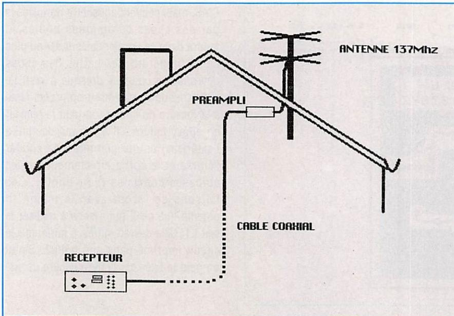
incrimine le préampli ou le récepteur, ou même l'antenne, alors qu'on a pris peu de soin à monter les connecteurs et qu'on se retrouve avec des courts-circuits par ci, par là. Ne pas oublier de vérifier plusieurs fois avant de brancher.
