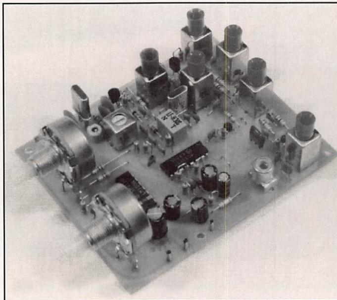
FET (NEC 41137) double porte monté en préampli. Il est suivi d'un transistor du même type, monté lui en mélangeur.
