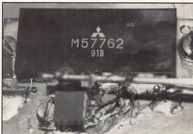
Photo 3 - Gros plan sur le câblage d'un hybride.
