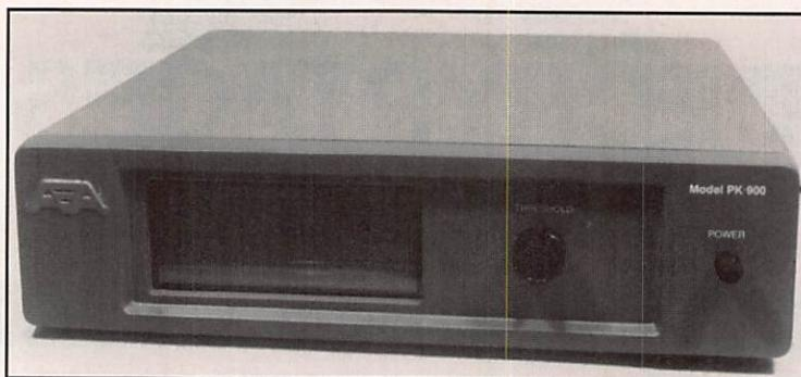
PK-900). Ceci mis à part, on retrouve les mêmes connexions : ports radio 1 et 2 (avec jacks pour un câblage en réception seule), prises pour contrôle oscilloscope, prise pour FSK et potentiomètres de réglage de niveau AFSK. L'alimentation est en 13,8 V et requiert 1,1 A.
