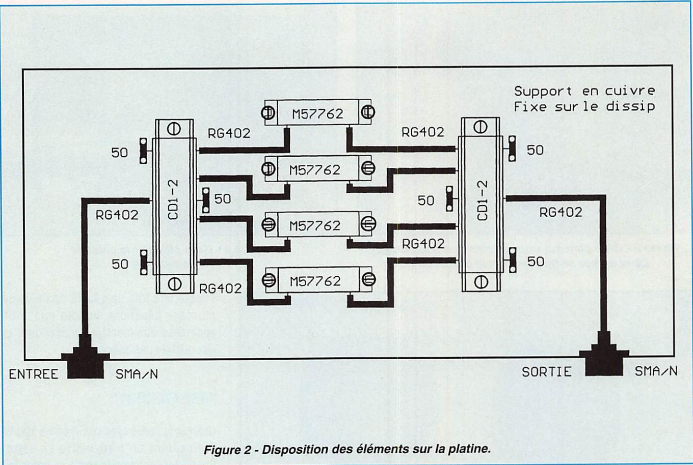
Figure 2 - Disposition des éléments sur la platine.
