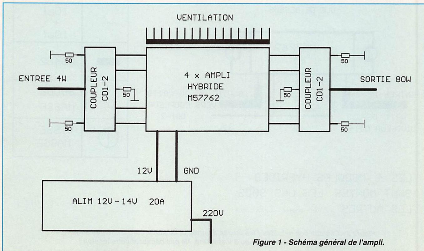
Figure 1 - Schéma général de l'ampli.
