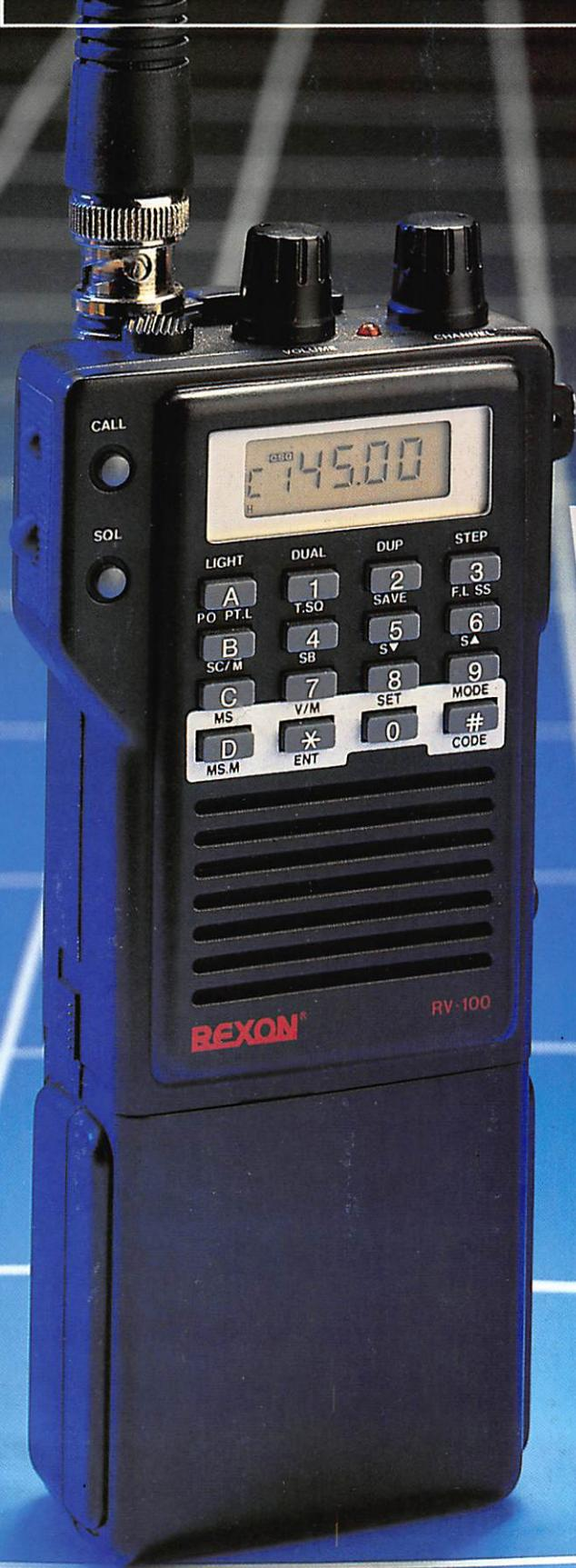
**MODE DUPLEX :** *Utilisation en semi duplex . L'émission se fait sur une autre fréquence (programmée) que la réception.*
