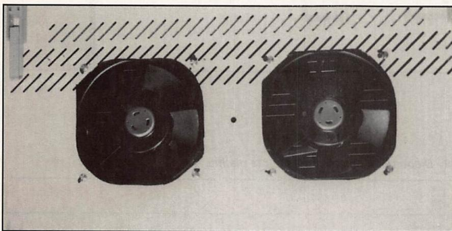
Photo 5 - Les deux ventilateurs sous le dissipateur.
