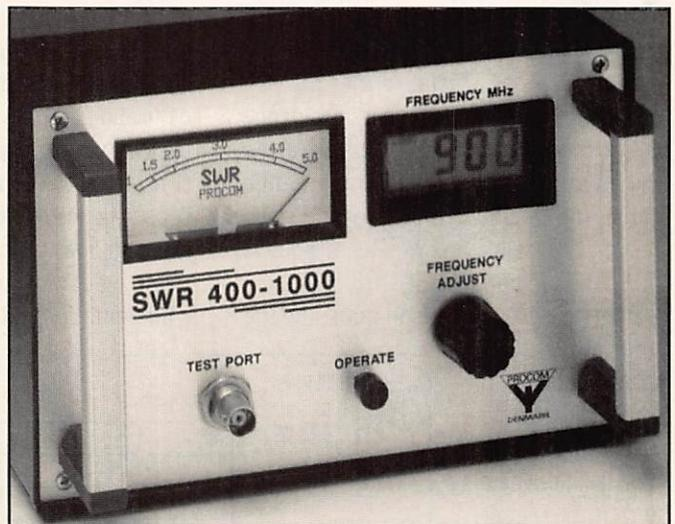
capable de couvrir la gamme de 400 à 1000 MHz (il existe également un modèle couvrant de 66 à 470 MHz).
