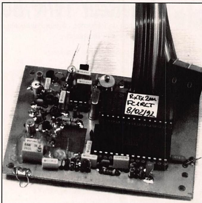
simplicité de mise en œuvre. La programmation parallèle et le décalage interne de 10,7 MHz de ce circuit sont ses principaux atouts. Il ne faut pas non plus trop espérer de ce circuit : construire un synthétiseur universel avec une plus grande plage de fréquences pose
