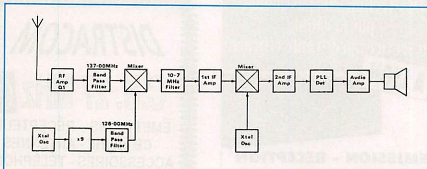
Fig. 1 - Synoptique du récepteur 137 MHz Cirkit.
