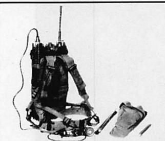
AN/PRC 9A - Emetteurs/récepteurs portables en FM. AN/PRC 9A couvre de 27 à 38,9 MHz - Couverture en accord continu par maître oscillateur - Puissance HF : 1 W - Très bel état, vendu avec garantie - Livré avec documentation, schémas.
