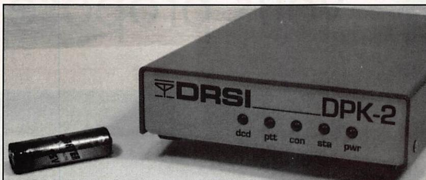
TCM 3105, est à 1200 baud (donc uniquement VHF-UHF). Un emplacement pour connecteur standard "TAPR" est prévu afin d'implanter un modem 9600-19200 baud pour les satellites.
