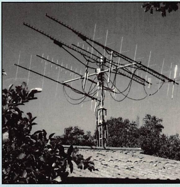
Pour les antennes, le choix est très large : une 2 x 9 el. croisés pour la bande 144 MHz et une 2 x 19 el. croisés sur 70 cm. Sur ces deux bandes, c'est la polarisation circulaire droite, créée par déphasage, qui est utilisée. Sur la bande 1200 MHz, l'antenne est une 2 x 55 éléments en polarisation linéaire.
