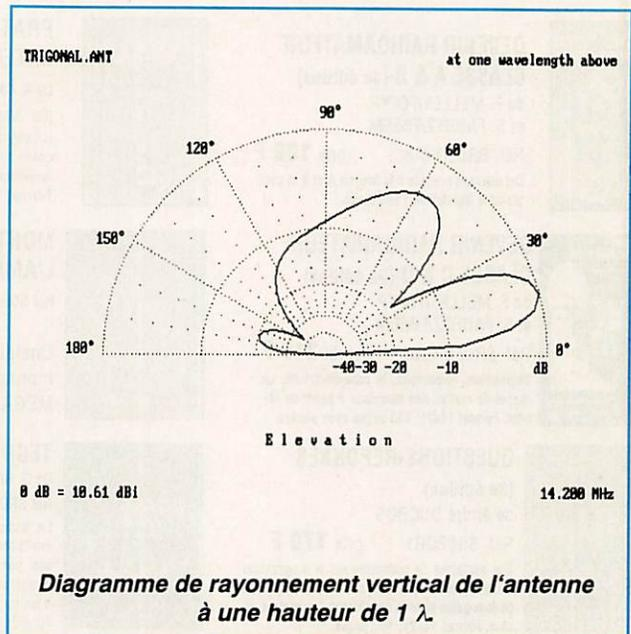
en V) ressemble beaucoup à l'antenne "Jungle-Job", déjà décrite dans ces colonnes (voir bibliographie). Si vous recherchez un rapport avant-arrière très élevé, l'espacement entre les extrémités des radiateurs et des réflecteurs peut être ajusté selon la procédure de couplage critique mentionnée en bibliographie.
