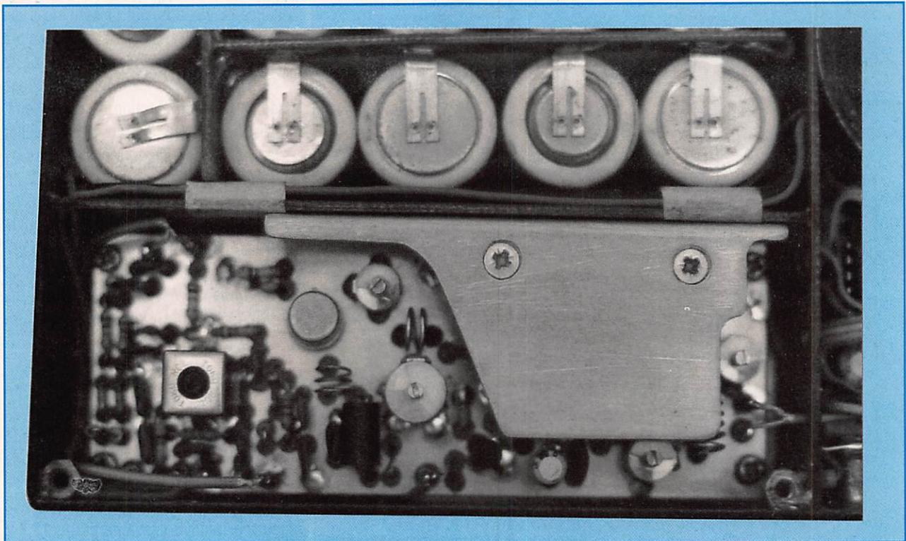
**La platine émission montée dans le transceiver.**
