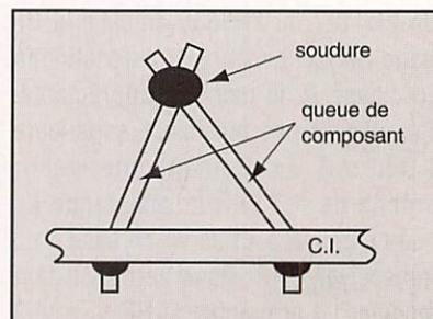
**Système utilisé pour la mesure d'intensité.**
