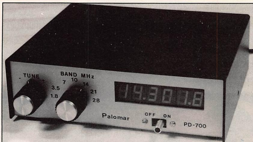
avec le fréquencemètre. Ces derniers sont soigneusement repérés et dotés, à l'autre extrémité, de jacks de couleurs différentes. Le prélèvement s'effectue par l'intermédiaire de condensateurs de faible valeur (déjà soudés sur les câbles). Des schémas détaillés sont fournis pour l'installation sur les SWAN et ATLAS. Il ne reste plus qu'à relier le fréquencemètre à une source d'alimentation 12 V sous 200 mA. Cette tension pourra, dans certains cas, être prélevée sur le transceiver.
