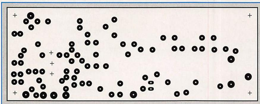
**Dessin du circuit imprimé à l'échelle 1.**
