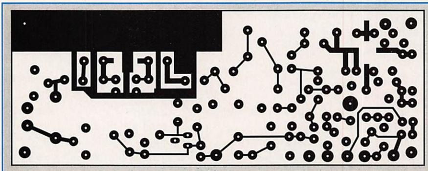
**Dessin du circuit imprimé à l'échelle 1.**
