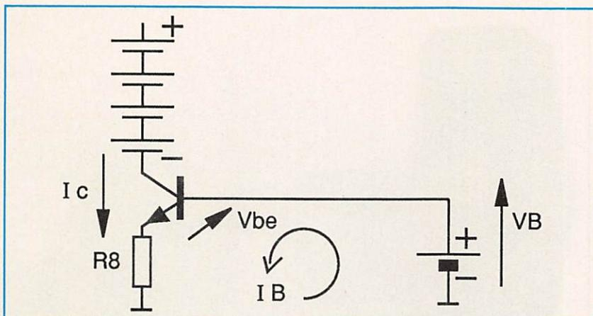
Figure 6 : Principe du générateur de courant.
