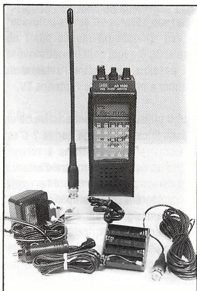
Un bon compromis : l'AOR AR-1500 est un scanner portable offrant 1000 mémoires et la possibilité d'écouter la BLU. De plus, il est livré avec de nombreux accessoires.
