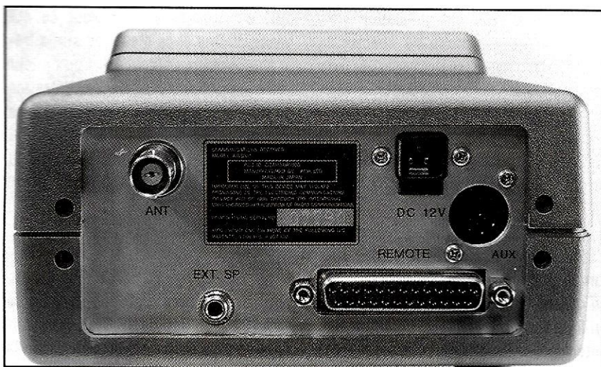
Une seule prise antenne à l'arrière de ce modèle (AOR AR-3000), mais on notera la présence d'un connecteur "REMOTE", pour piloter le scanner par ordinateur.
