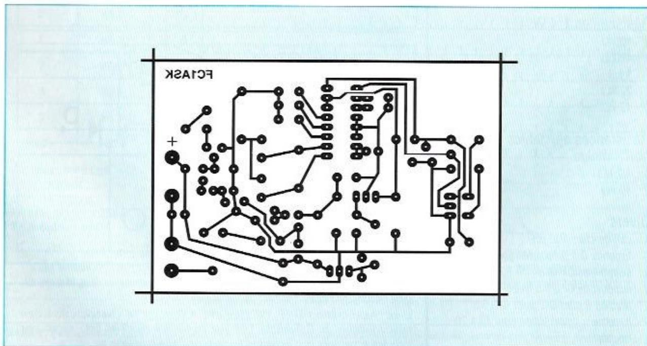
Dessin du circuit imprimé à l'échelle 1
