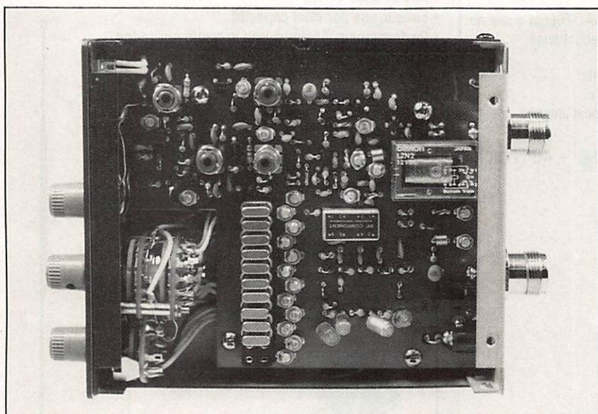
On note le mélangeur DBM et les quartz de l'oscillateur local.
