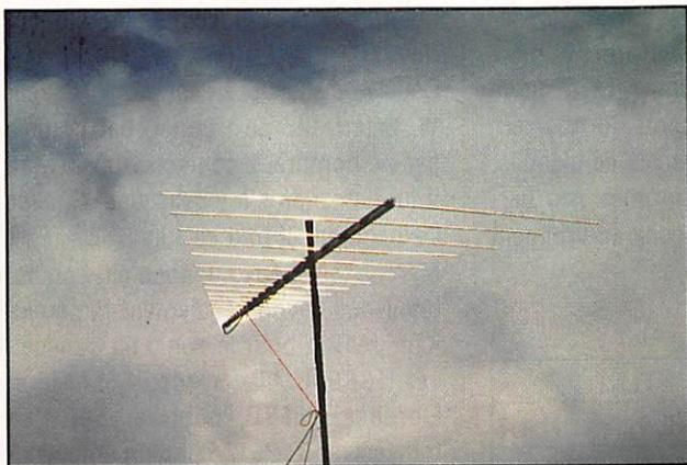
Antenne 50 MHz/144/432 avec rotateur à ficelles.
