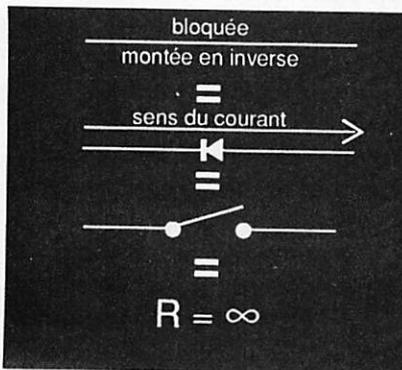
Une diode montée dans le sens inverse du courant s'oppose à son passage. Elle est dite bloquée et montée en inverse.
