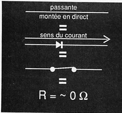
La diode ci-dessus est montée dans le sens du courant. Elle est dite passante, elle est montée en direct.
