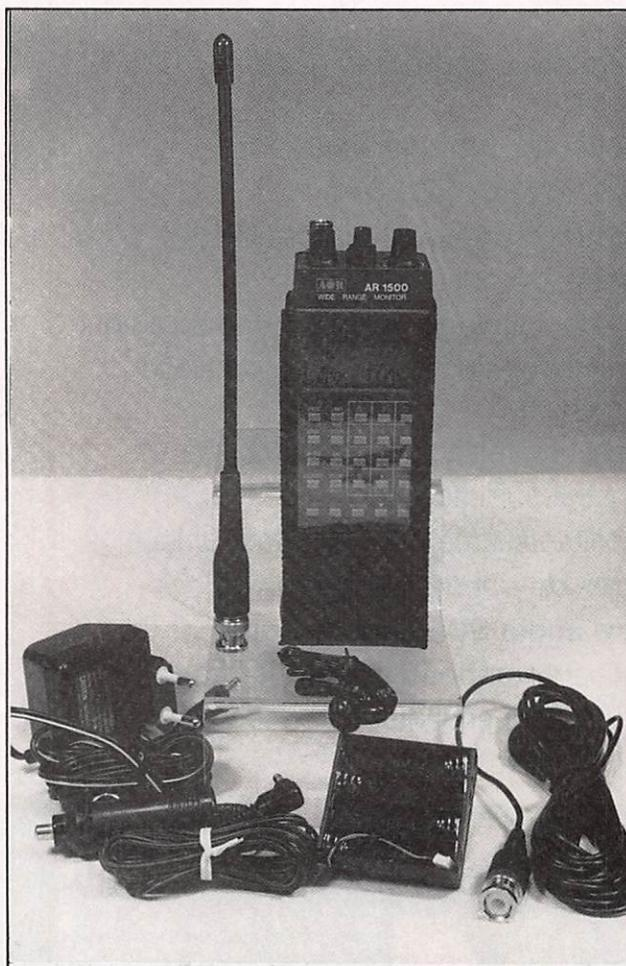
livré en configuration très complète : accu NiCad, chargeur, housse de protection, antenne «boudin» et antenne filaire, écouteur, prise d'alimentation allume-cigare prévue pour le mobile et bac à piles supplémentaire.
