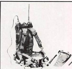
AN/PRC 9A - Emetteurs/récepteurs portables en FM. AN/PRC 9A couvre de 27 à 38,9 MHz - Couverture en accord continu par maître oscillateur - Puissance HF : 1 W - Très bel état, vendu avec garantie - Livré avec documentation, schémas.
