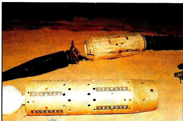
Un câble sous-marin et son répéteur.
